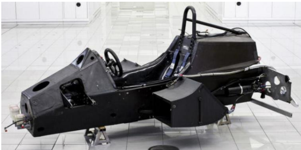
Slika 8. McLaren MP4/1C je prvi F1 bolid s monokokom od ugljičnih vlakana [11]
