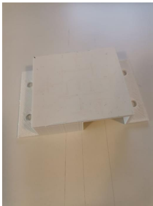
Slika 4.9 Isprintano kućište senzora
