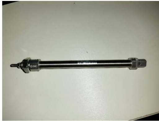
Slika 3.2 Dvoradni cilindar C85E10-100
