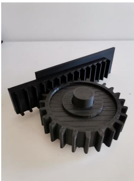
Slika 4.3 Isprintan mehanizam za pokretanje vrata
