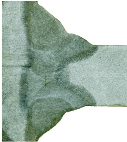
Slika 21: Uvećan prikaz zavara modela [16]
