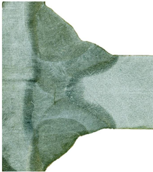
Slika 21: Uvećan prikaz zavara modela [16]
