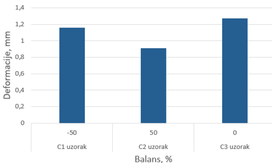
Slika 38. Ovisnost kutne deformacije o balansu - uzorci C1, C2 i C3
