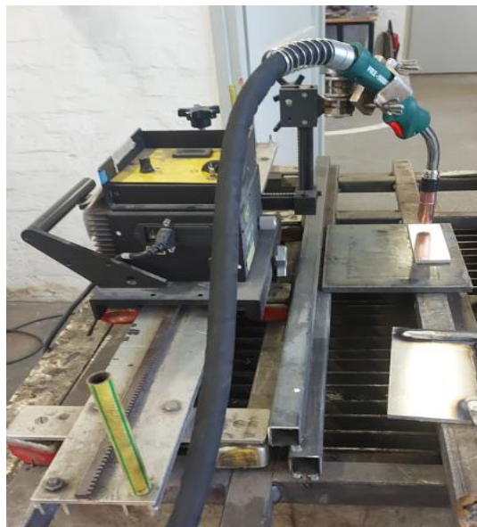
Slika 26. Uređaj za automatizirano gibanje pištolja
