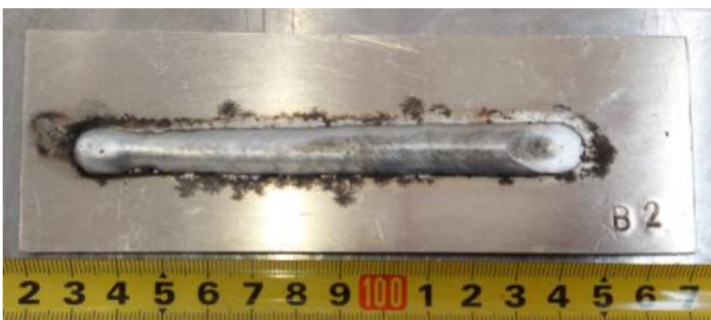
Slika 30. Uzorak A2, B2, C3 - izmjenična struja, I = 150 \text{ A} , U = 23,3 \text{ V} , f = 144,8 \text{ Hz} , EN = 0 \%
