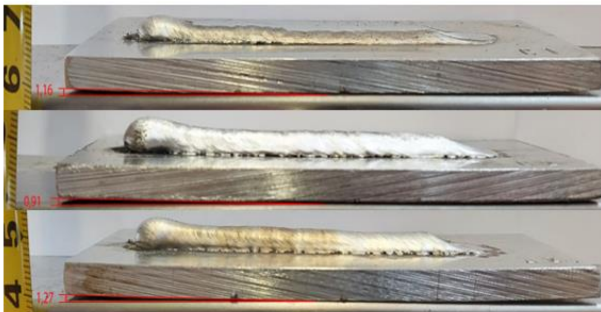
Slika 38. Ovisnost kutne deformacije o balansu - uzorci C1, C2 i C3
