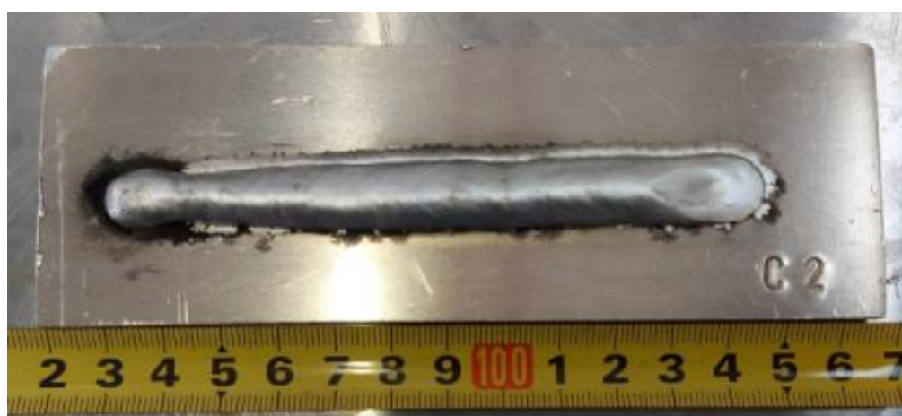
Slika 33. Uzorak C2 - izmjenična struja, I = 150 \text{ A} , U = 22,8 \text{ V} , EN = 50 \%
