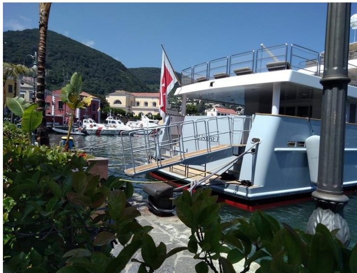
Slika 6. Teleskopska pasarela za jahte tvrtke Fem strutture
