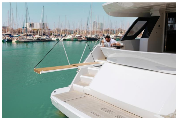
Slika 7. Teleskopska pasarela LaPassarella tvrtke Besenzoni
