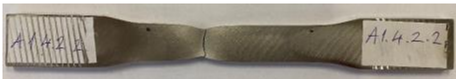
Slika 18. Epruveta poslije ispitivanja
