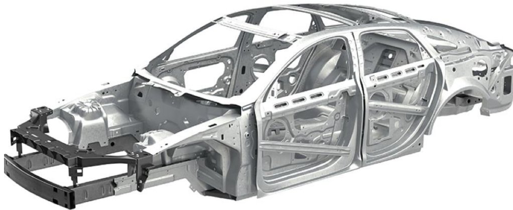
Slika 5. Čelični kostur automobila [13]
