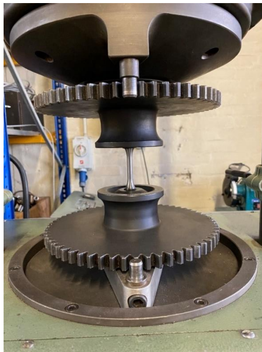
Slika 33. Prihvatni sustav za epruvetu na umaralici
