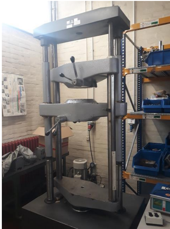
Slika 16. Kidalica EU 40 MOD
