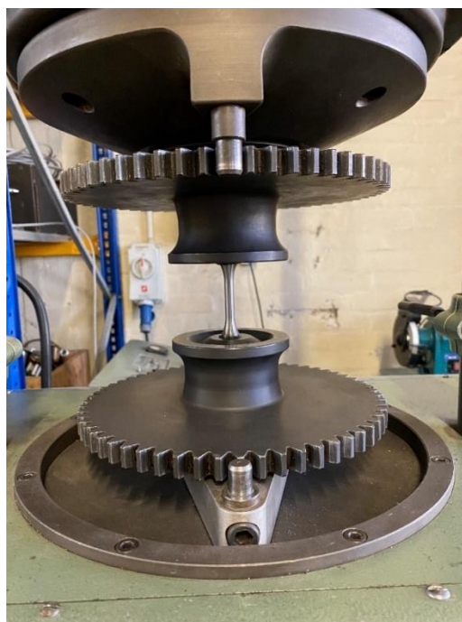
Slika 33. Prihvatni sustav za epruvetu na umaralici
