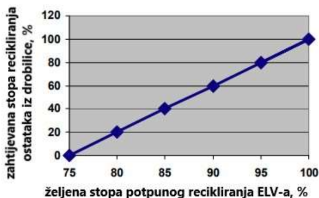
Slika 6. Zahtijevane stope recikliranja ostataka drobilica za ostvarivanje visoke ukupne stope recikliranja vozila
