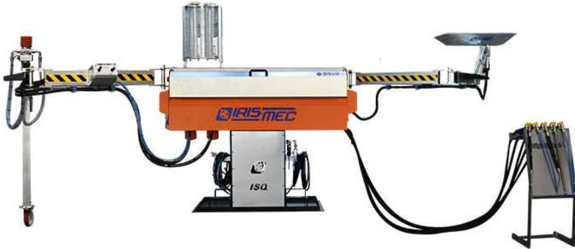
**Slika 13. Uredaj za ispuštanje tekućina iz vozila ISQ VS [18]**
