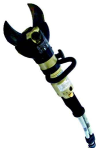
Slika 21. Hidrauličke škare [26]
