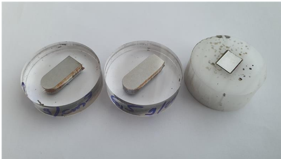
Slika 19 Uzorci sinteriranog čelika Astaloy Mo+0,2C
