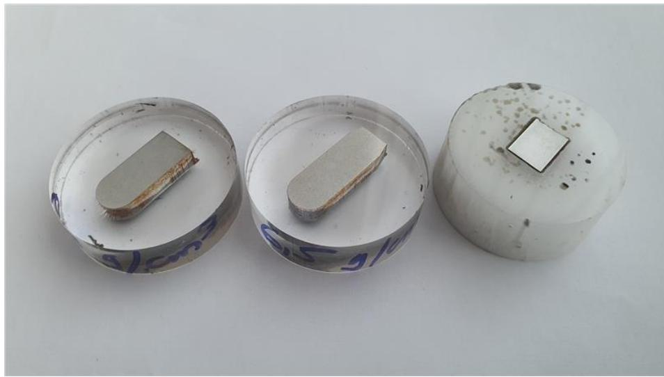
**Slika 19** Uzorci sinteriranog čelika Astaloy Mo+0,2C
