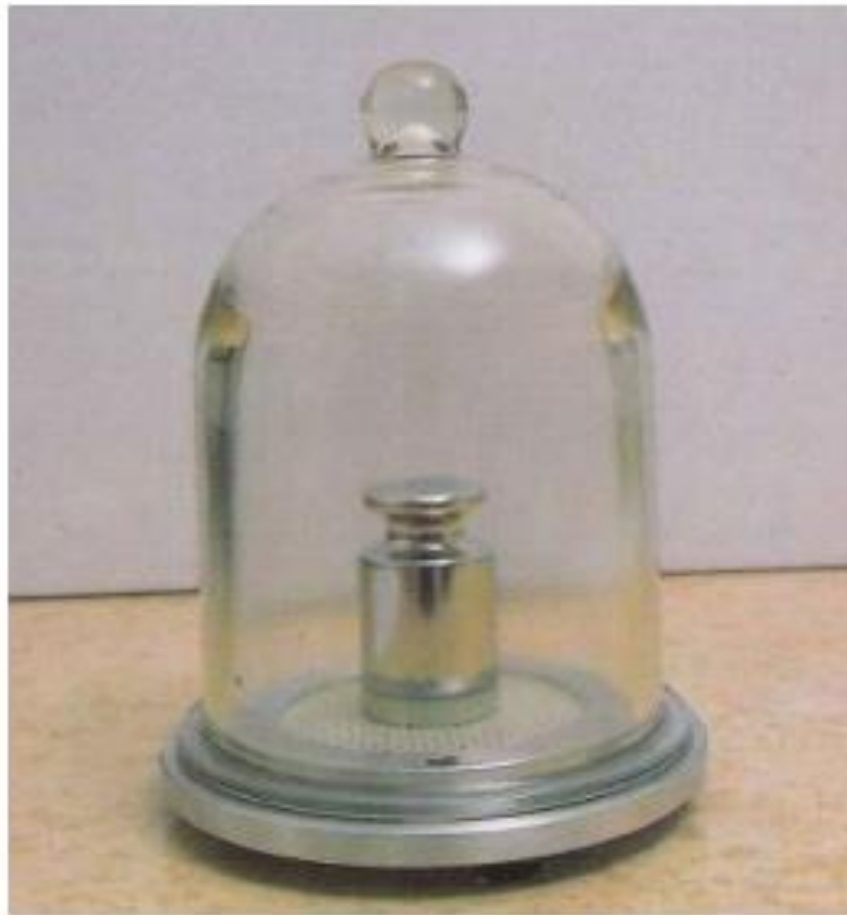
Slika 13. Nacionalni etalon kilograma Republike Hrvatske [17]
