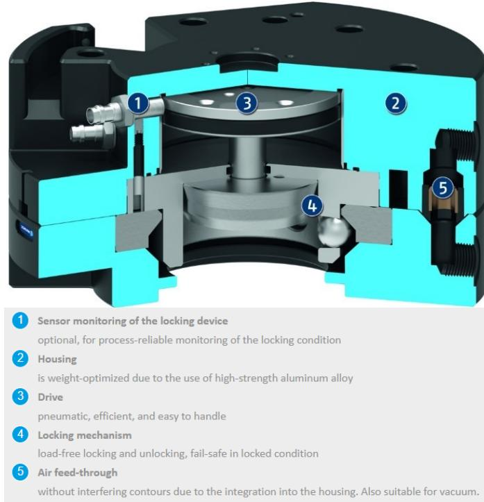
**Slika 13: Presjek sustava za automatsku zamjenu alata [ 8 ]**
