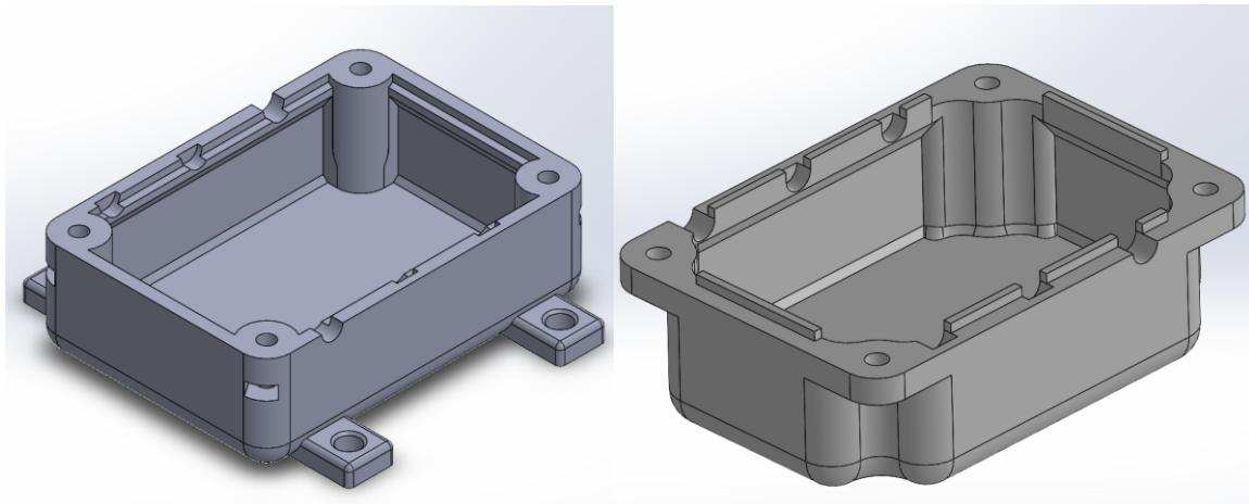
Slika 7: Modeli dijelova kućišta
