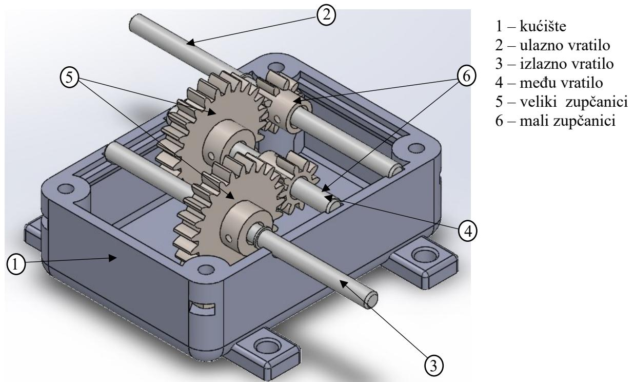
Slika 6: CAD model reduktora bez poklopca
