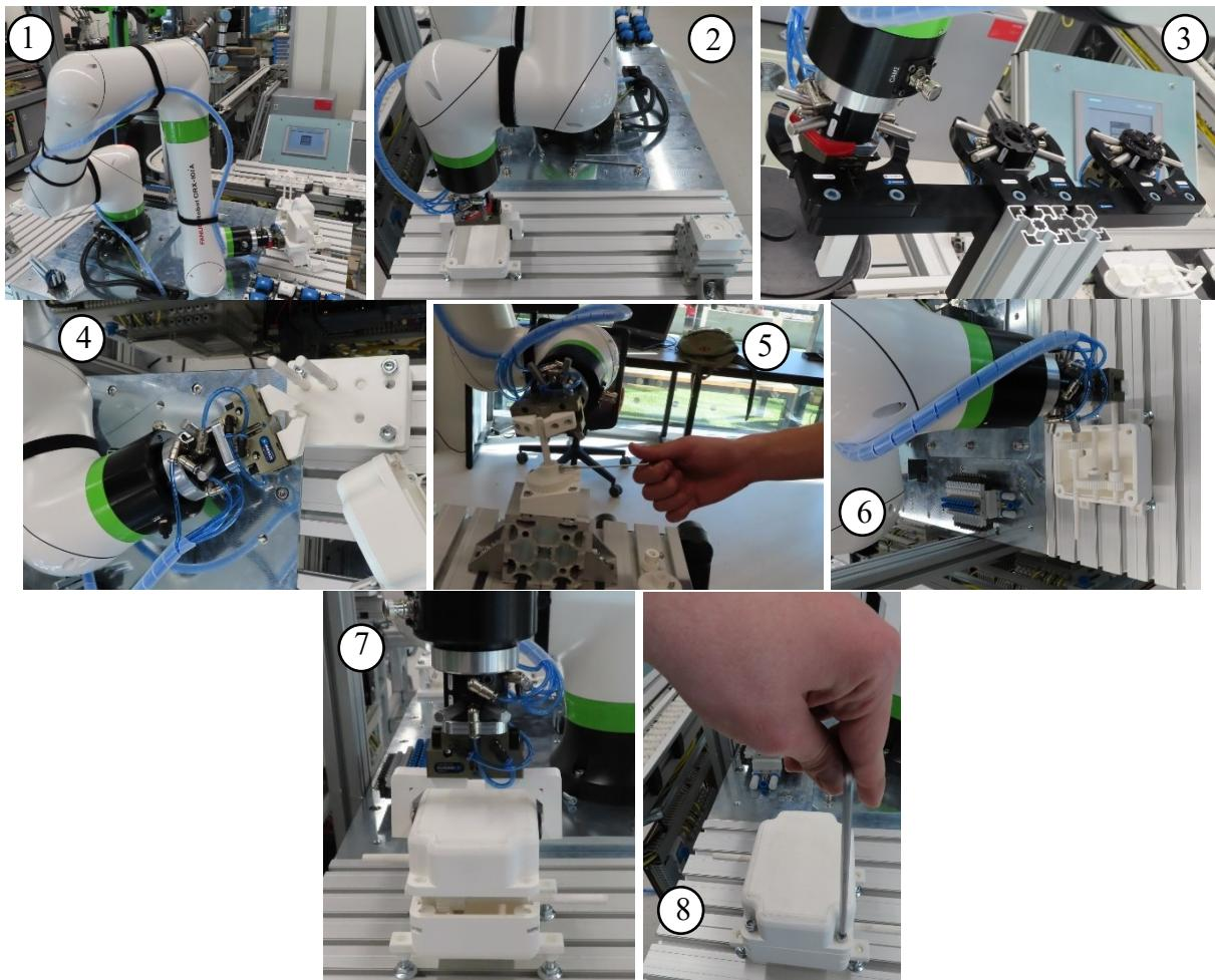
1 – uzimanje gornjeg dijela kućišta, 2 – stavljanje donjeg dijela kućišta na radno mjesto, 3 – zamjena alata, 4 – uzimanje vratila, 5 – montaža zupčanika na vratilo, 6 – stavljanje zupčanika u kućište, 7 – stavljanje gornjeg dijela kućišta na mjesto, 8 – pritezanje vijaka koji spajaju kućište
