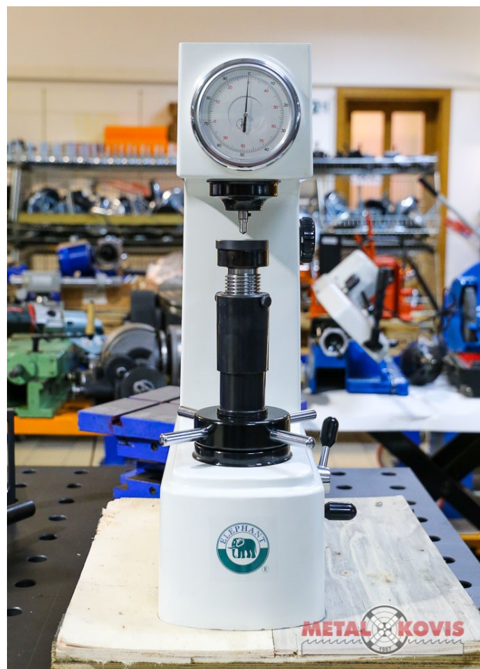
Slika 16. Uređaj za mjerenje tvrdoće Rockwell metodom [16]
