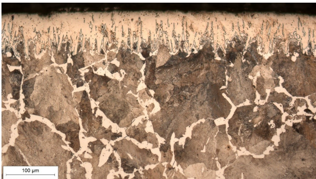
Slika 23. Borirani uzorak, uvećanje 200x
