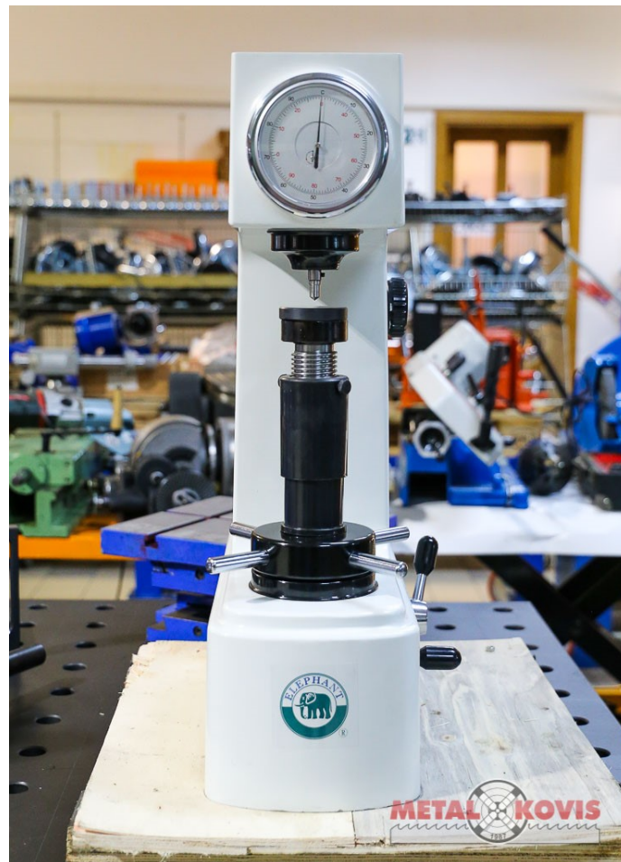
Slika 16. Uređaj za mjerenje tvrdoće Rockwell metodom [16]
