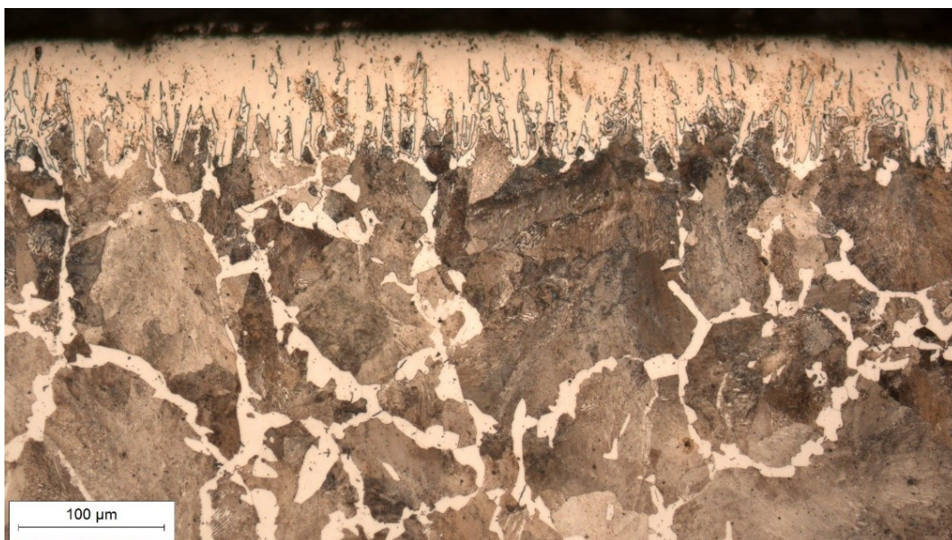
Slika 23. Borirani uzorak, uvećanje 200x
