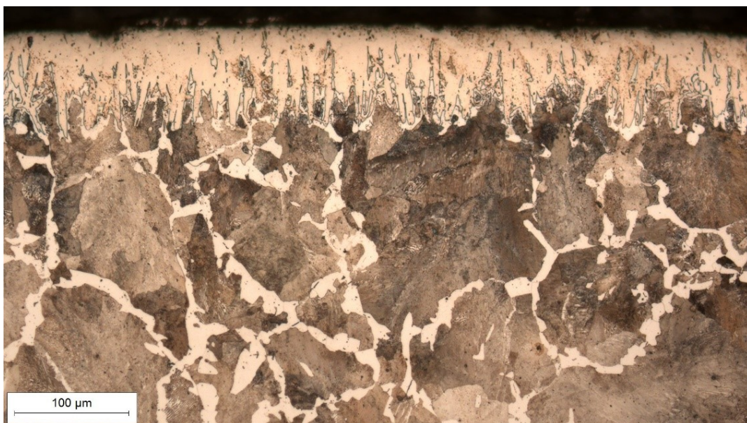
Slika 23. Borirani uzorak, uvećanje 200x
