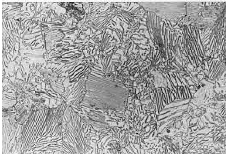
Slika 3. Mikrostruktura poboljšanog čelika [8]
