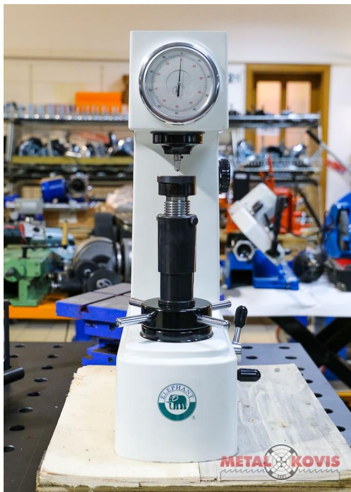
Slika 16. Uređaj za mjerjenje tvrdoće Rockwell metodom [16]
