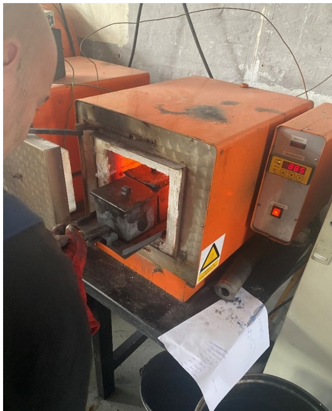
Slika 19. Stavljanje uzoraka u peć
