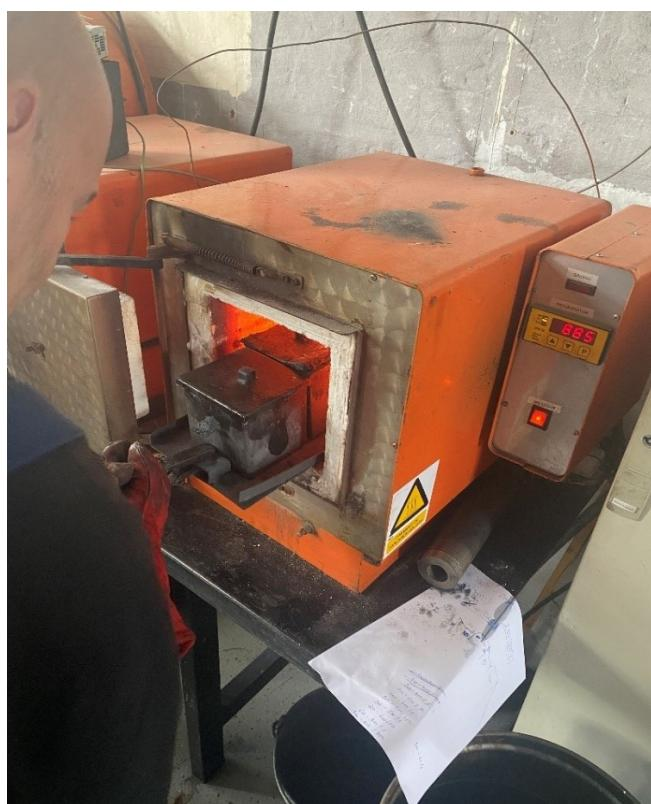
Slika 19. Stavljanje uzoraka u peć
