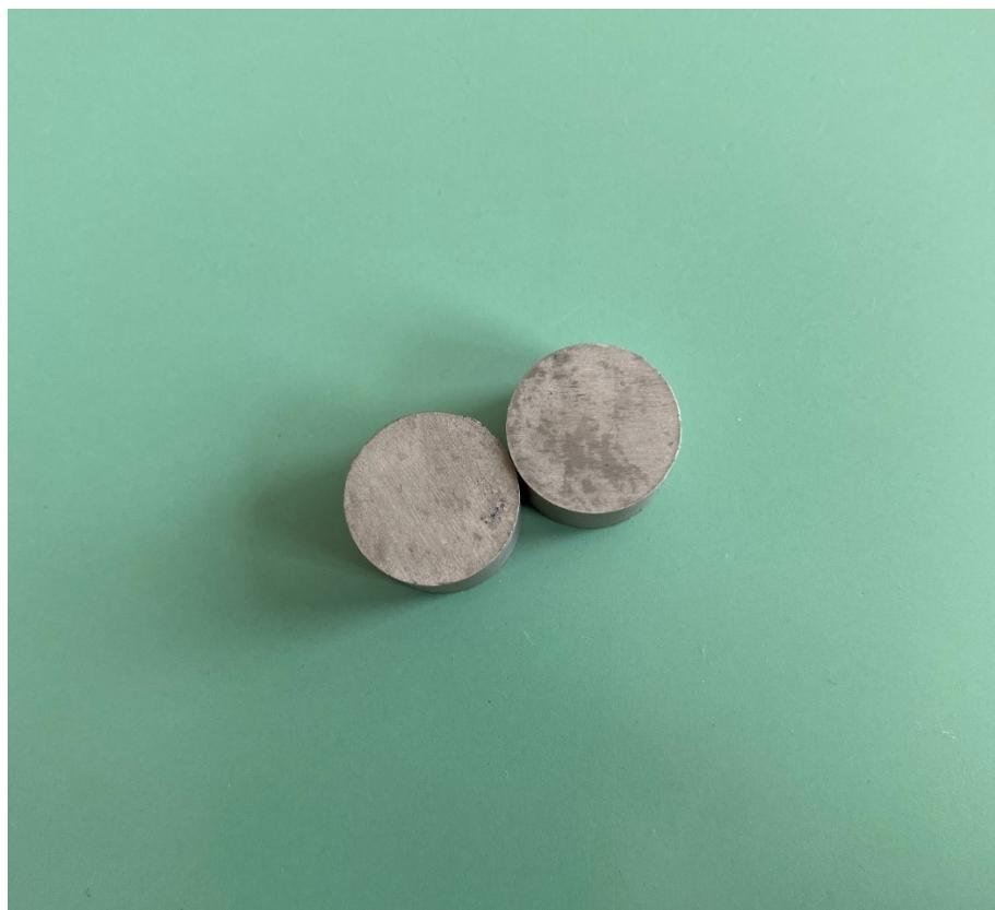
Slika 4. Uzorak od čelika C45
