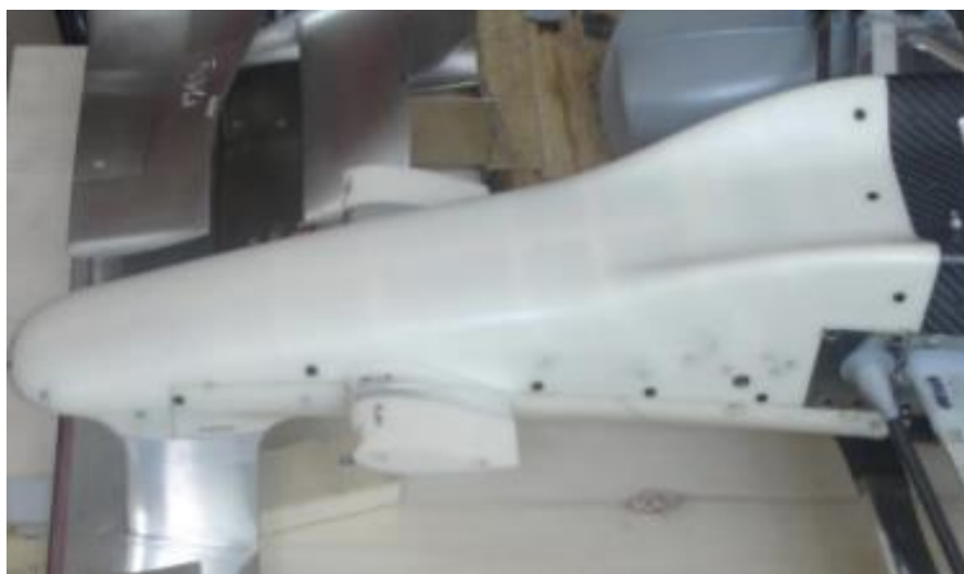
Slika 11. Sklop „nosa“ bolida [12]
