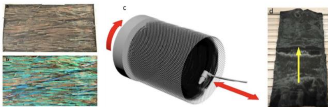
Slika 20. Postupak rekonstrukcije prostirke od ugljičnih vlakana [17]
