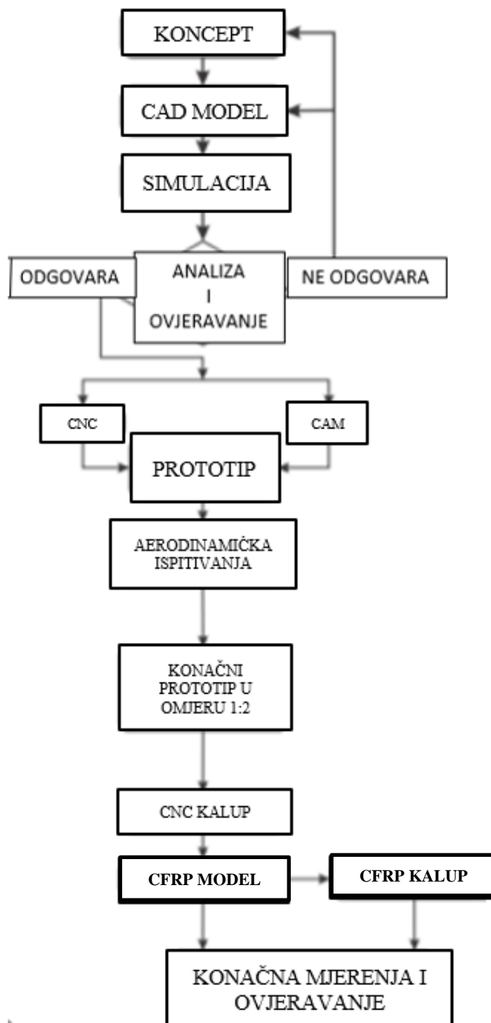
Slika 17. Metodologija proizvodnje elemenata bolida [12]
