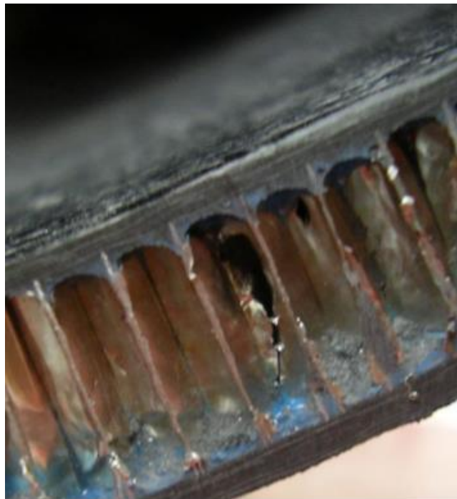
Slika 10. Primjer sendvič-konstrukcije korištene za izradu prednjeg krila bolida Formule 1 [12]
