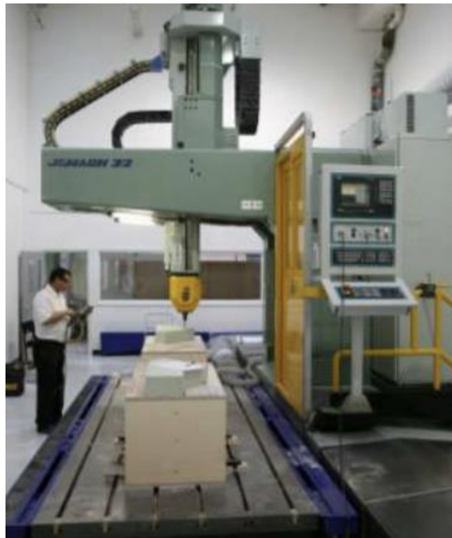
Slika 18. CNC-uređaj za oblikovanje kalupa [10]
