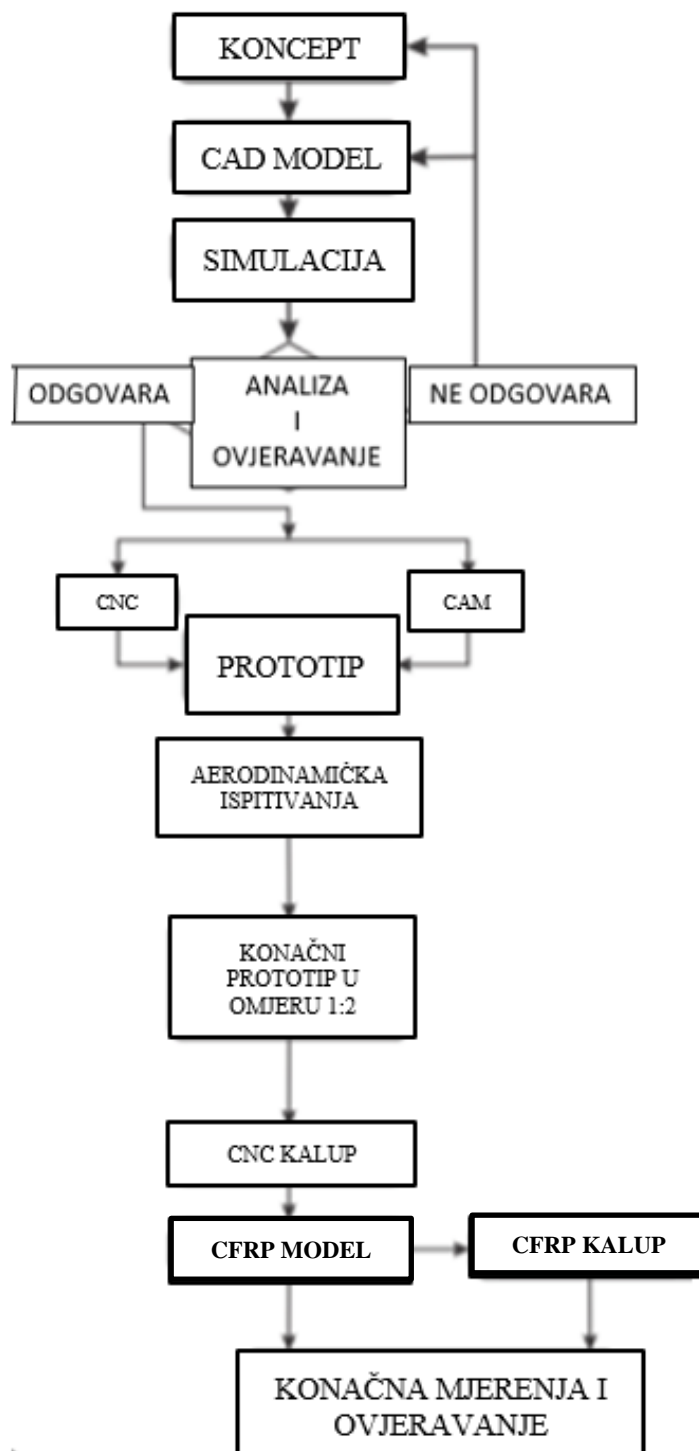
Slika 17. Metodologija proizvodnje elemenata bolida [12]
