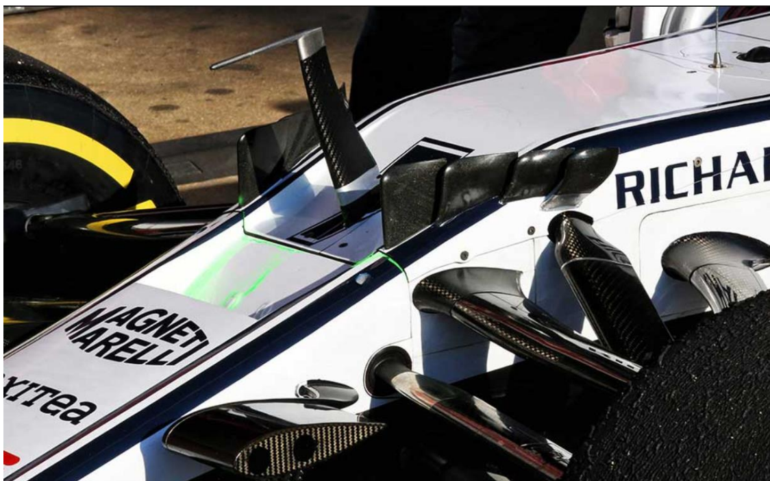
Slika 8. Kompozitna prednja osovina bolida [13]
