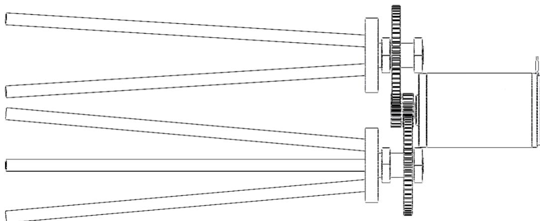
Slika 30. Skica konstrukcije prijenosnika i elektromotora
