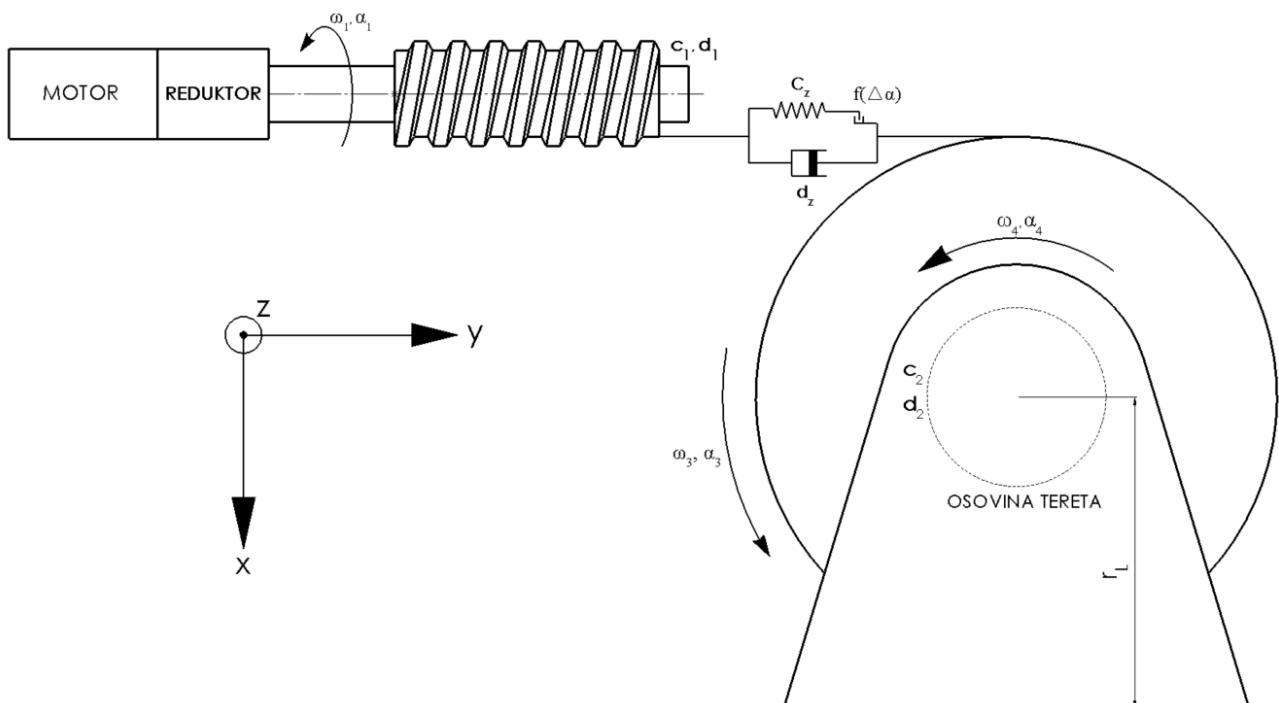
Slika 17. Shematski prikaz radnog mehanizma s pužnim prijenosom
