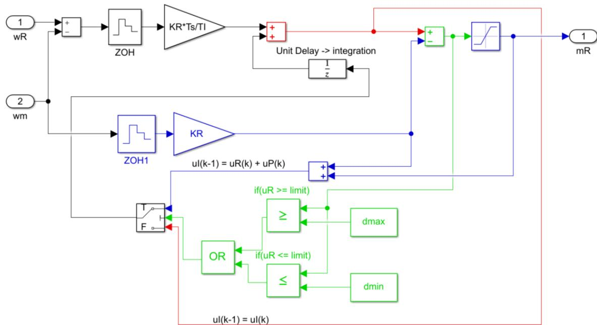
Slika 38. Shema diskretiziranog PI regulatora sa windupom
