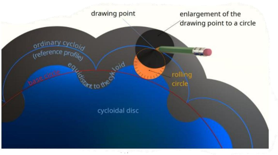
Slika 9. Izvedba cikloidnog diska s običnom cikloidom
