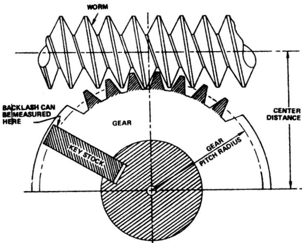
Slika 5. Način mjerjenja zračnosti
