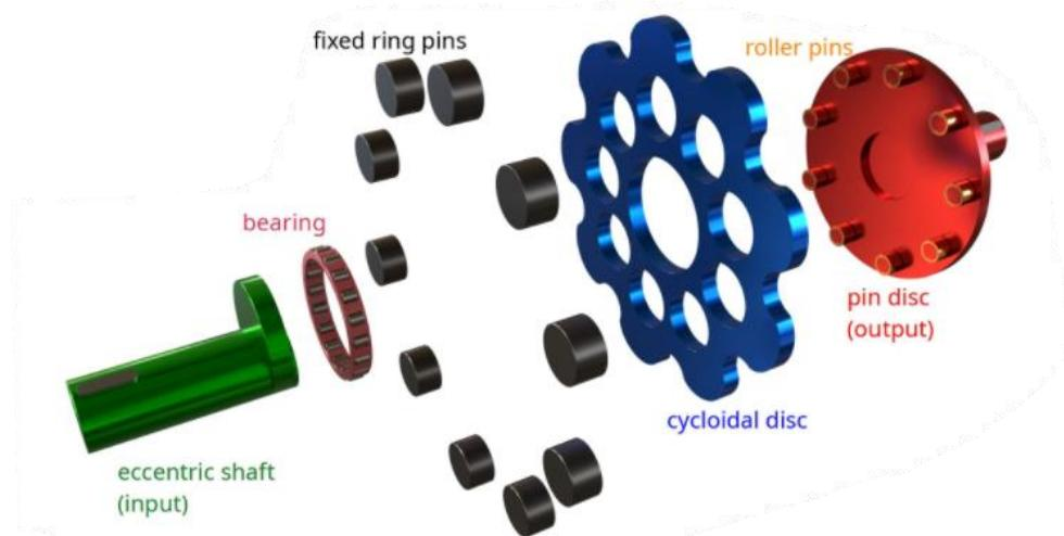
Slika 8. Izvedba cikloidnog prijenosnika
