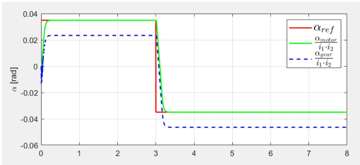
Slika 33. Graf kuta sustava za referentni kut od  $2^\circ$
