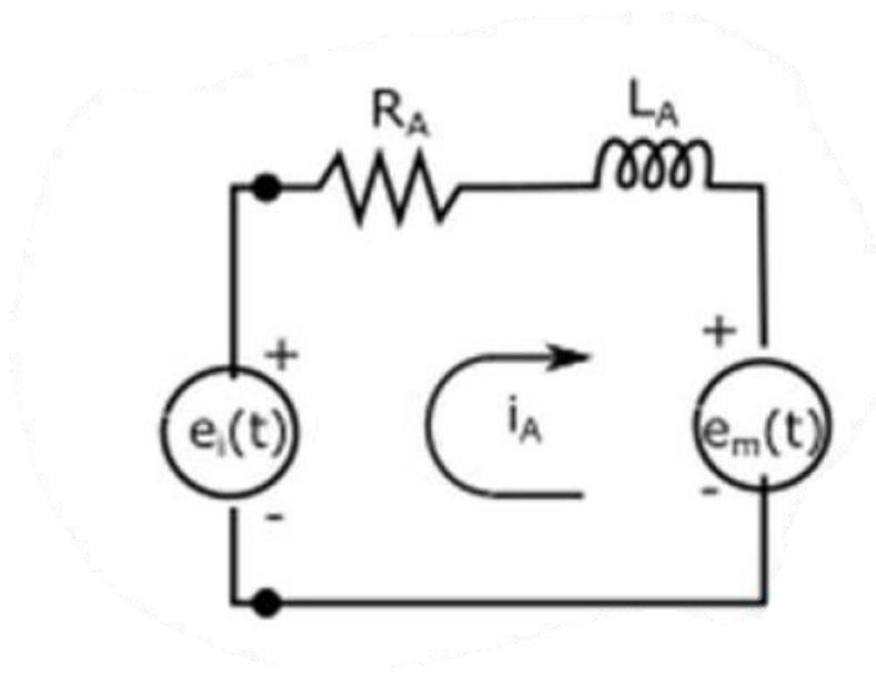
Slika 18. Strujni krug BLDC motora
