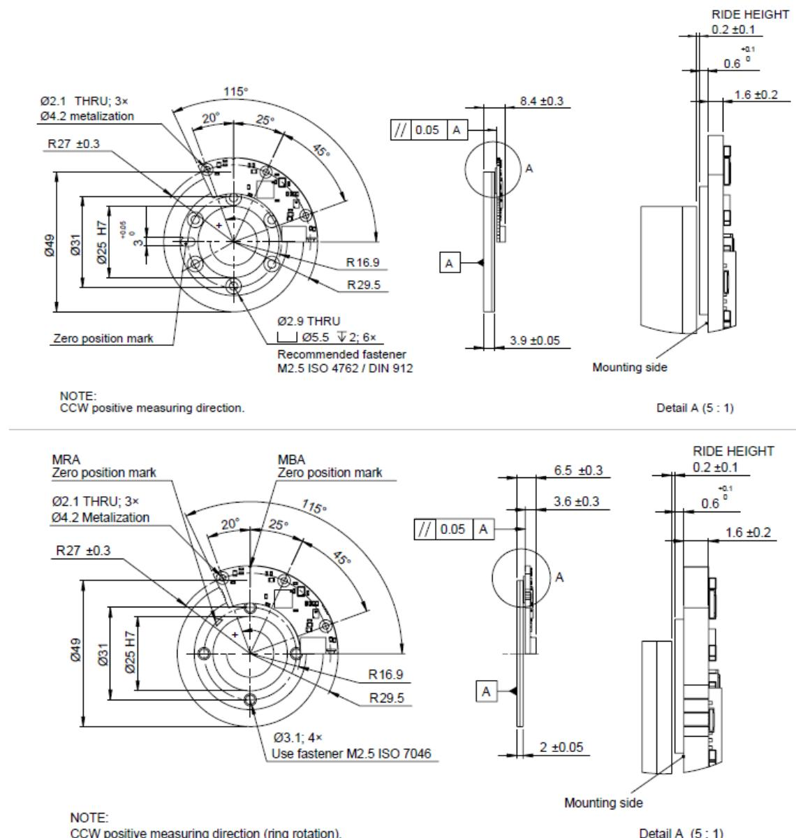
Slika 34. Dimenzije AksIM enkodera na motoru
