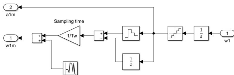
Slika 36. Simulink shema enkodera
