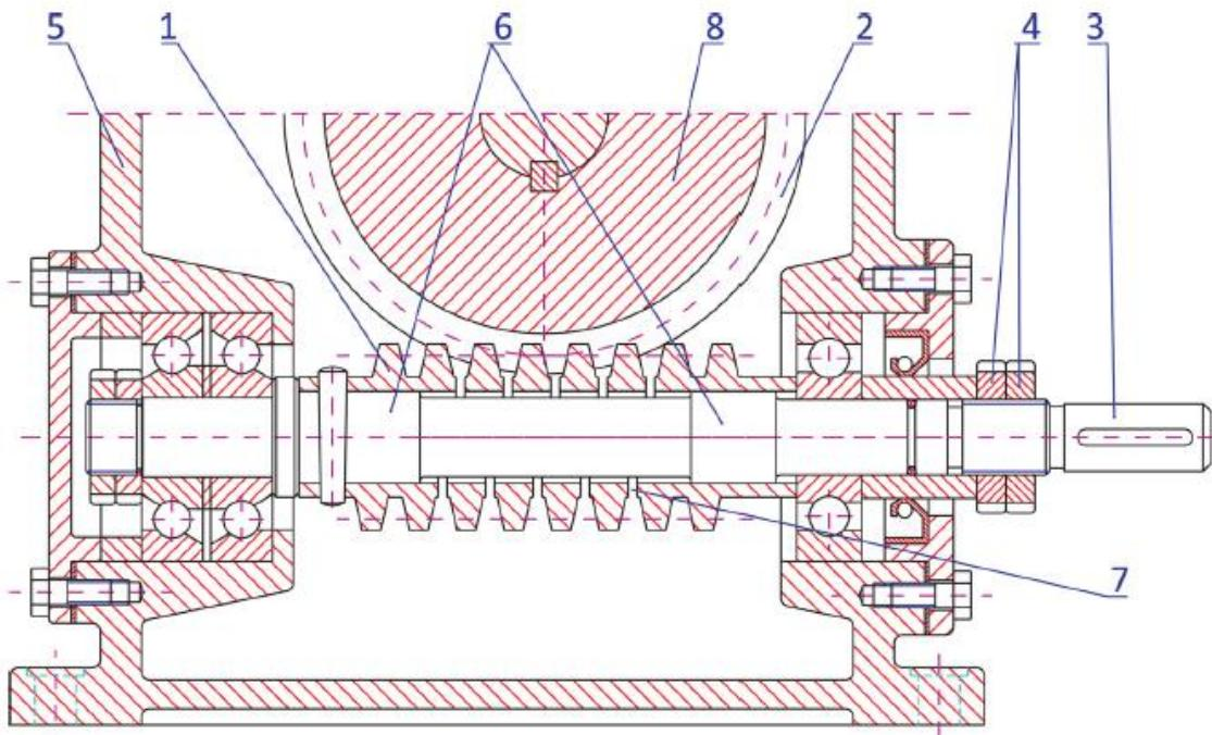
**Slika 15. Konstrukcija pužnog prijenosa sa lokalno aksijalnim adaptivnim pužnim vijkom:** 1 – pužni vijak, 2 – rub pužnog kola, 3 – vratilo, 4 – pritezna matica, 5 – kućište, 6 – ugrađena prilagodljiva površina pužnog vratila, 7- vijčani urezi, 8 – pužno kolo
