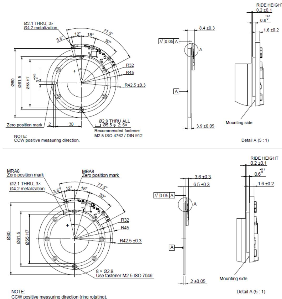
Slika 35. Dimenziije AksIM enkodera na zupčaniku
