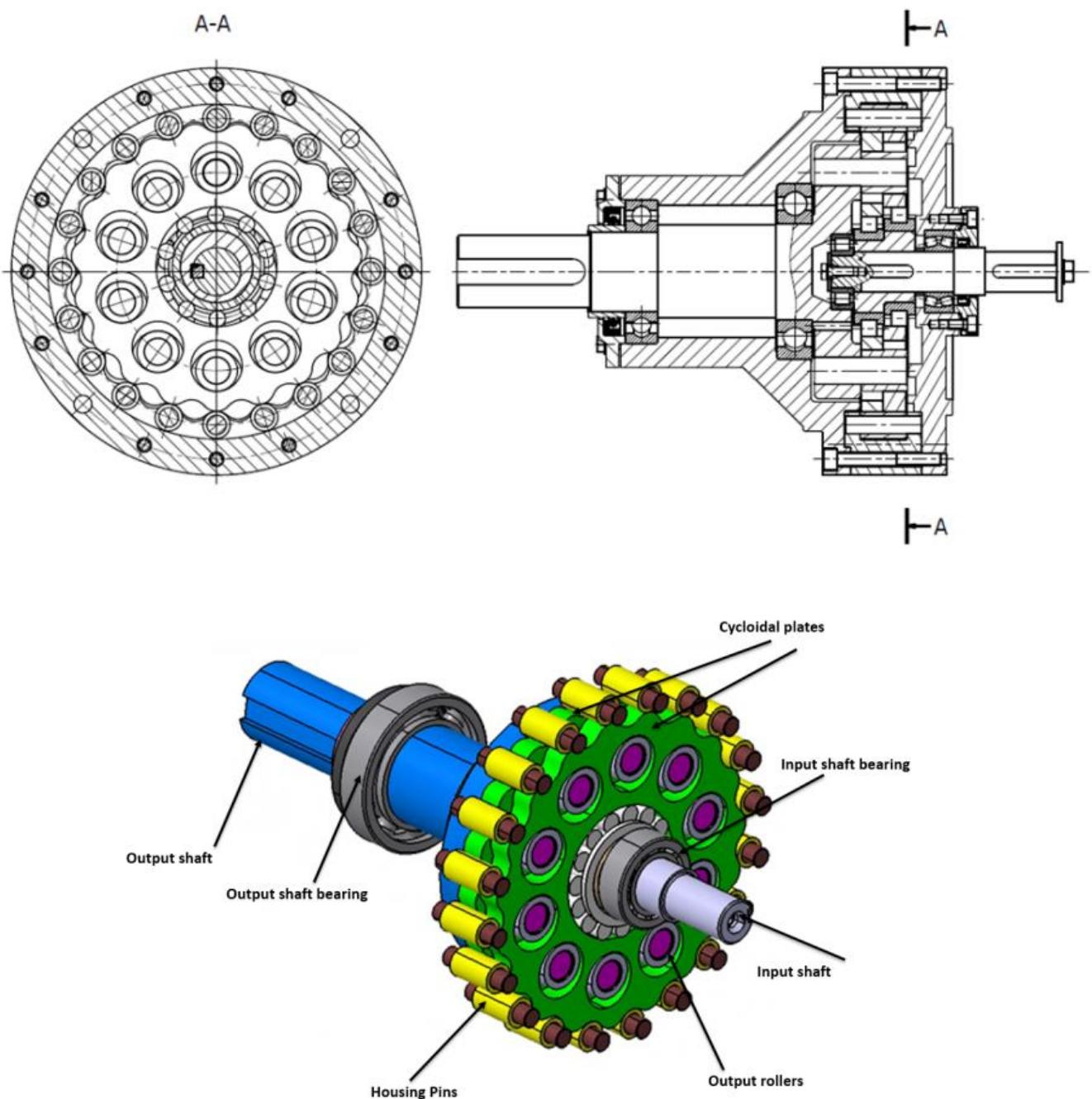
Slika 10. Cikloidni prijenosnik s dva diska (Lodzov stroj)
