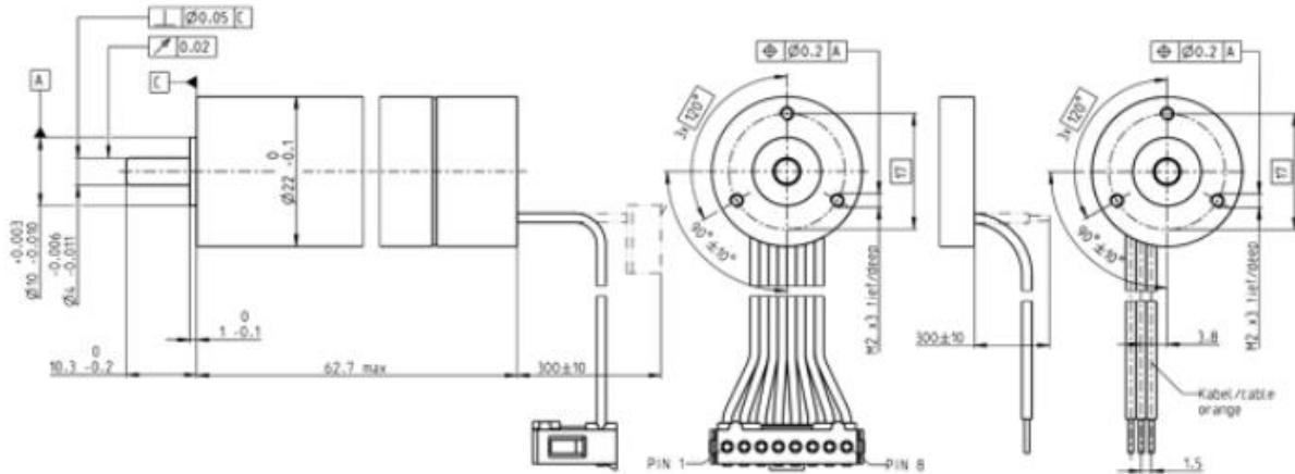
Slika 16. Dimenzije Maxon BLDC motora
