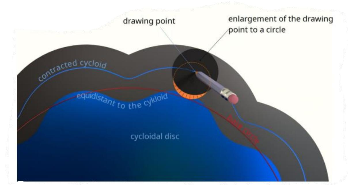
Slika 11. Izvedba cikloidnog diska sa stisnutom cikloidom
