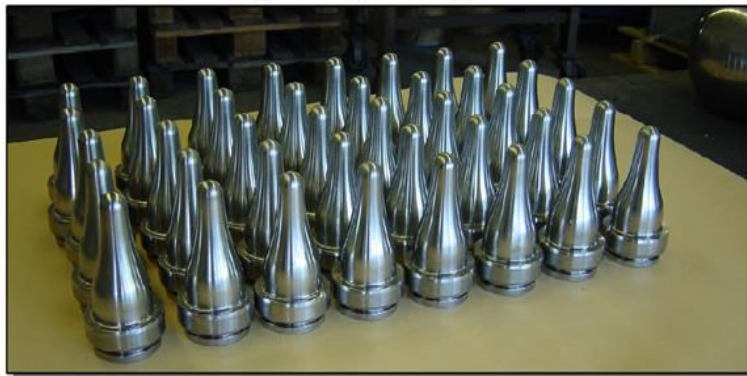
Slika 9. Borirani dijelovi u industriji stakla [19]
