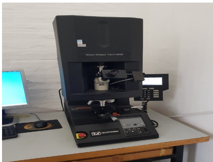
Slika 26. Mikrotvrdomjer Wilson-Wolpert Tukon 2100B
