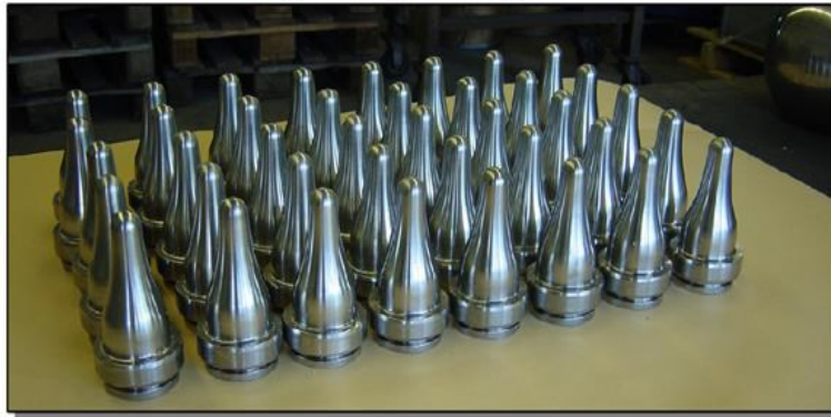
Slika 9. Borirani dijelovi u industriji stakla [19]
