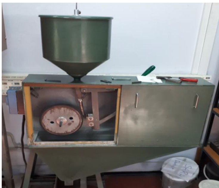
Slika 28. Uređaj za mjerenje otpornosti na abraziju
