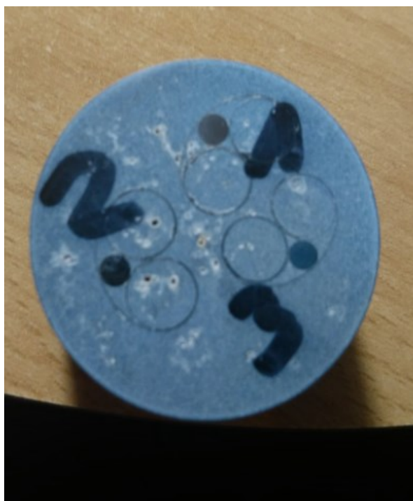
Slika 18. Uzorci zaliveni u polimernoj masi
