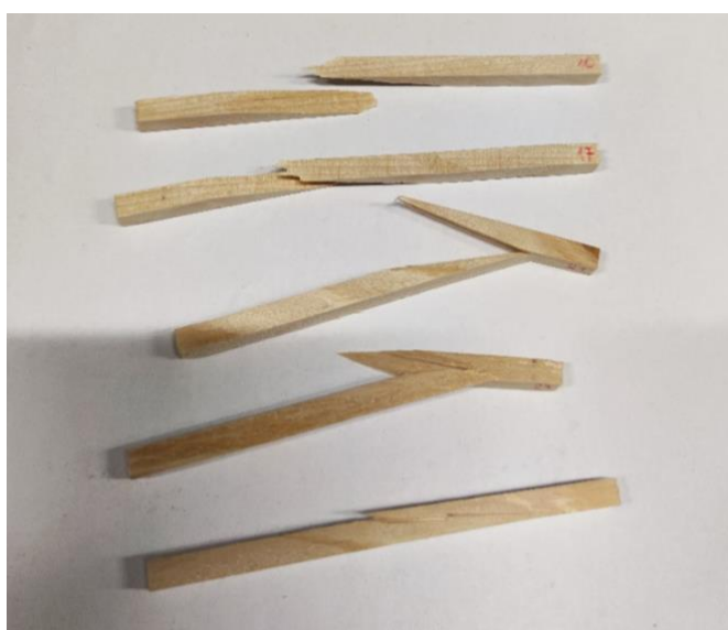
Slika 42. Ispitni uzorci iz skupine L90 nakon ispitivanja
