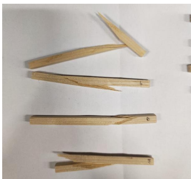
Slika 40. Ispitni uzorci iz skupine L45 nakon ispitivanja
