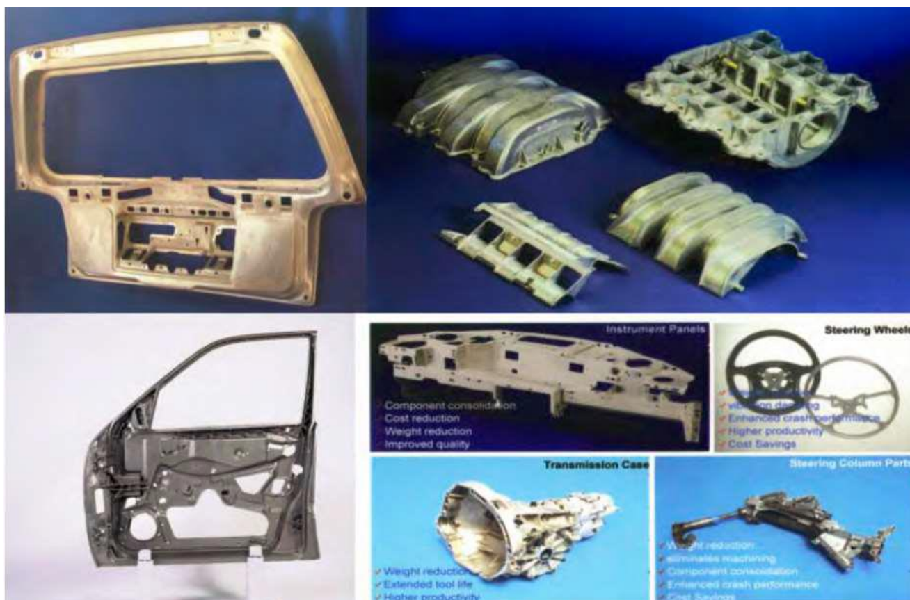
Slika 2. Tlačni lijev, odljevci od magnezijevskih legura [1]
