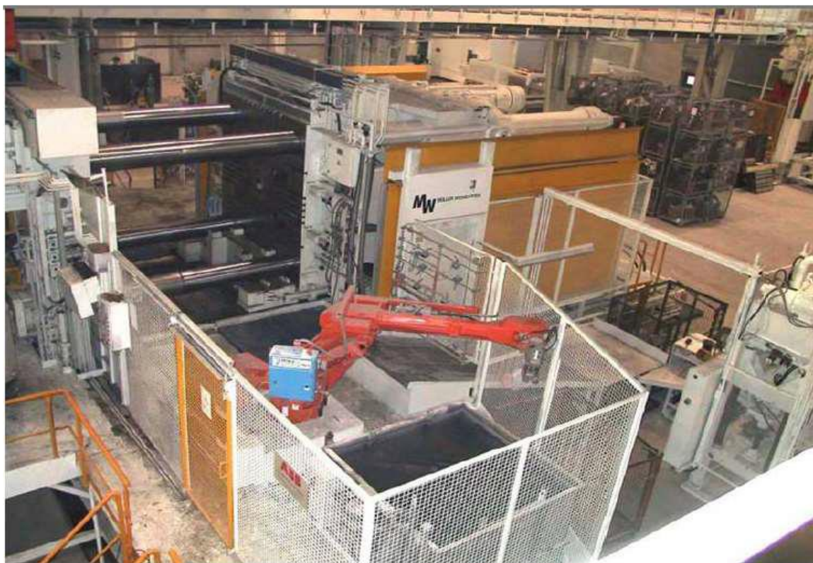
Slika 8. Prikaz stanice za tlačni lijev s robotom [1]
