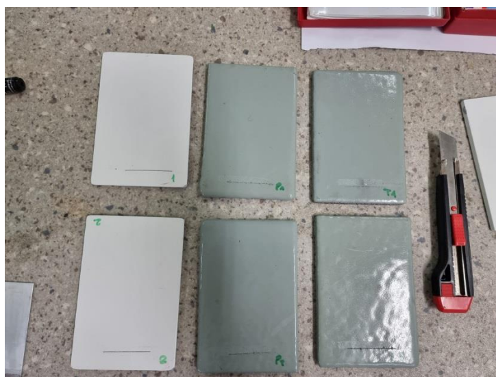
Slika 34. Uzorci sa zarezom prije komore.
