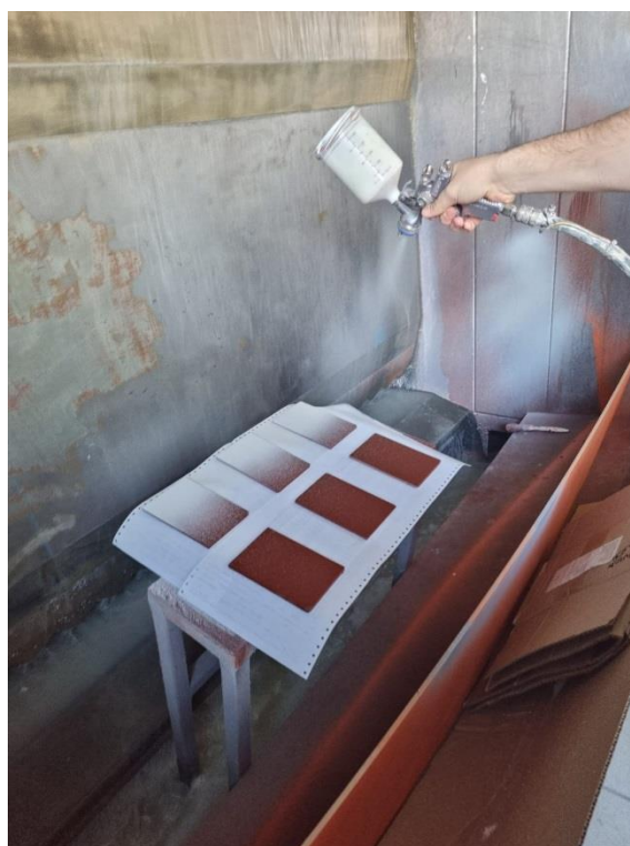
Slika 21. Nanošenje završnog sloja.
