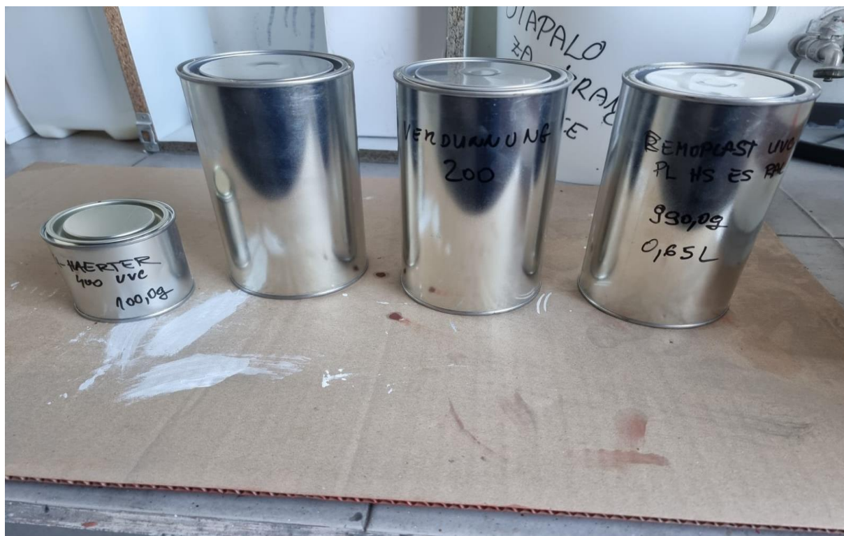
Slika 20. Komponente završnog premaza.
