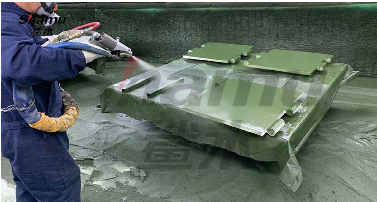
Slika 12. Nanošenje poliuree na vojne dijelove. [27]
