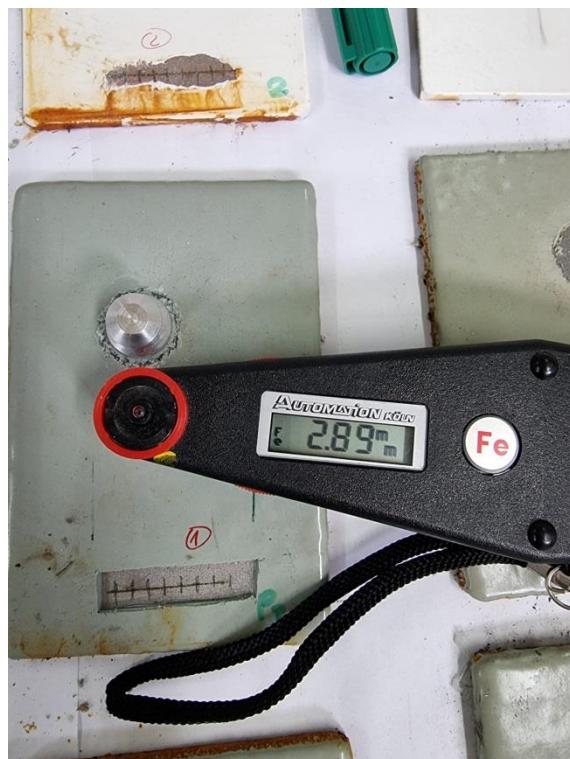
**Slika 31. Mjerenje uređajem QNix 1500.**
