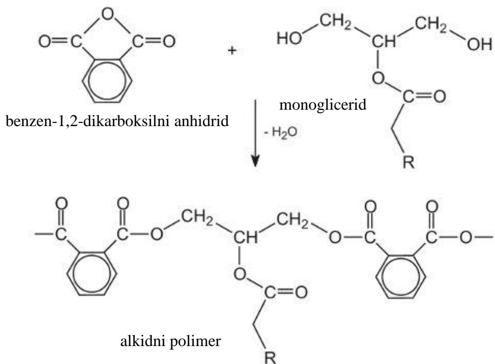
Slika 2. Nastajanje alkidnog polimera iz reakcija monoglycerida s anhidridom. [13]
