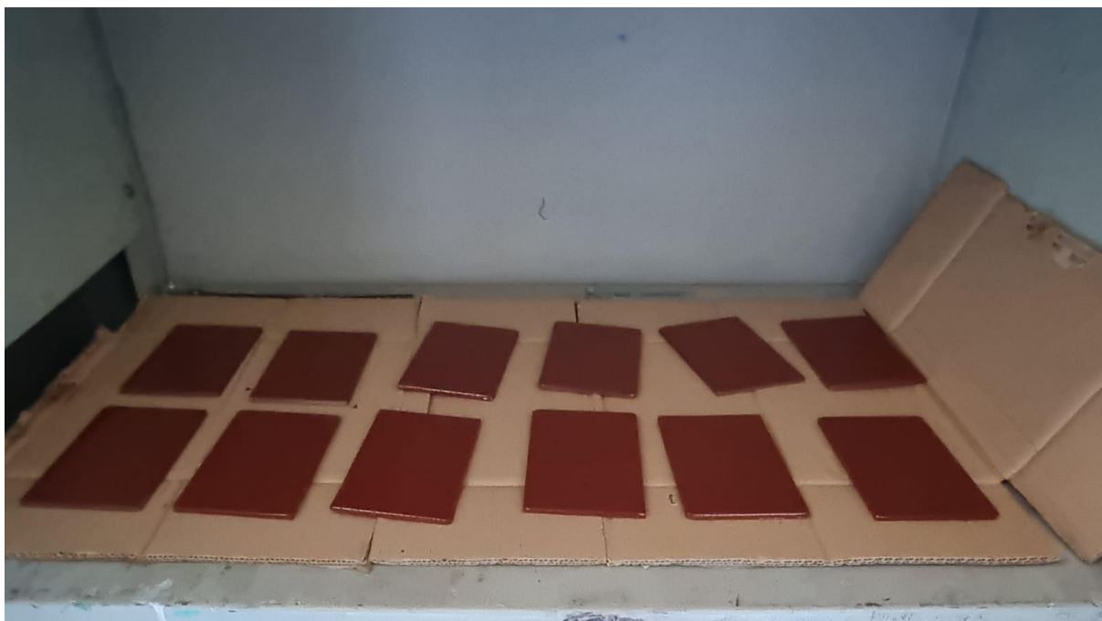
Slika 19. Sušenje uzoraka premazanih temeljnim slojem.
