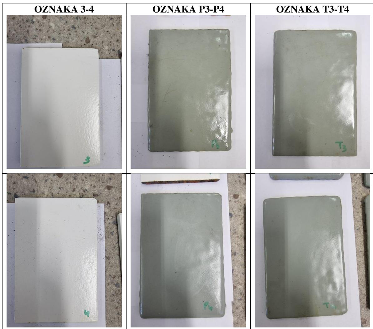
Slika 39. Prikaz uzorka nakon 120 h u vlažnoj komori.
