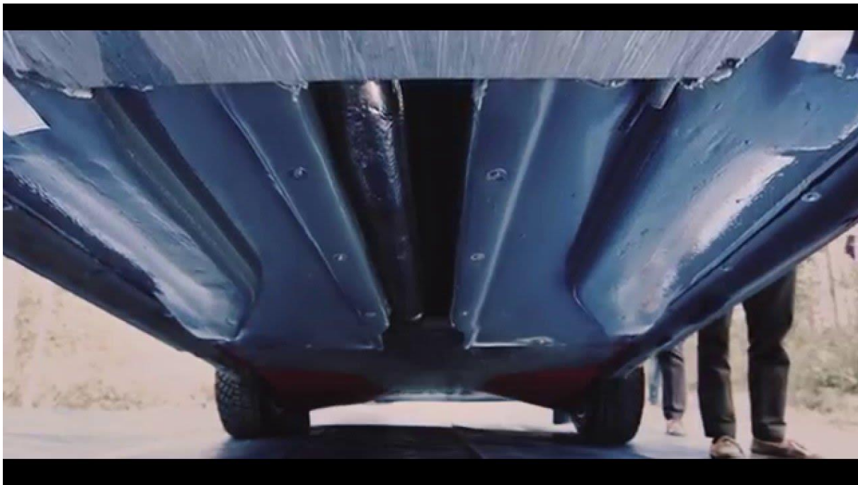
Slika 10. Podvozje automobila zaštićeno poliurea premazom. [25]
