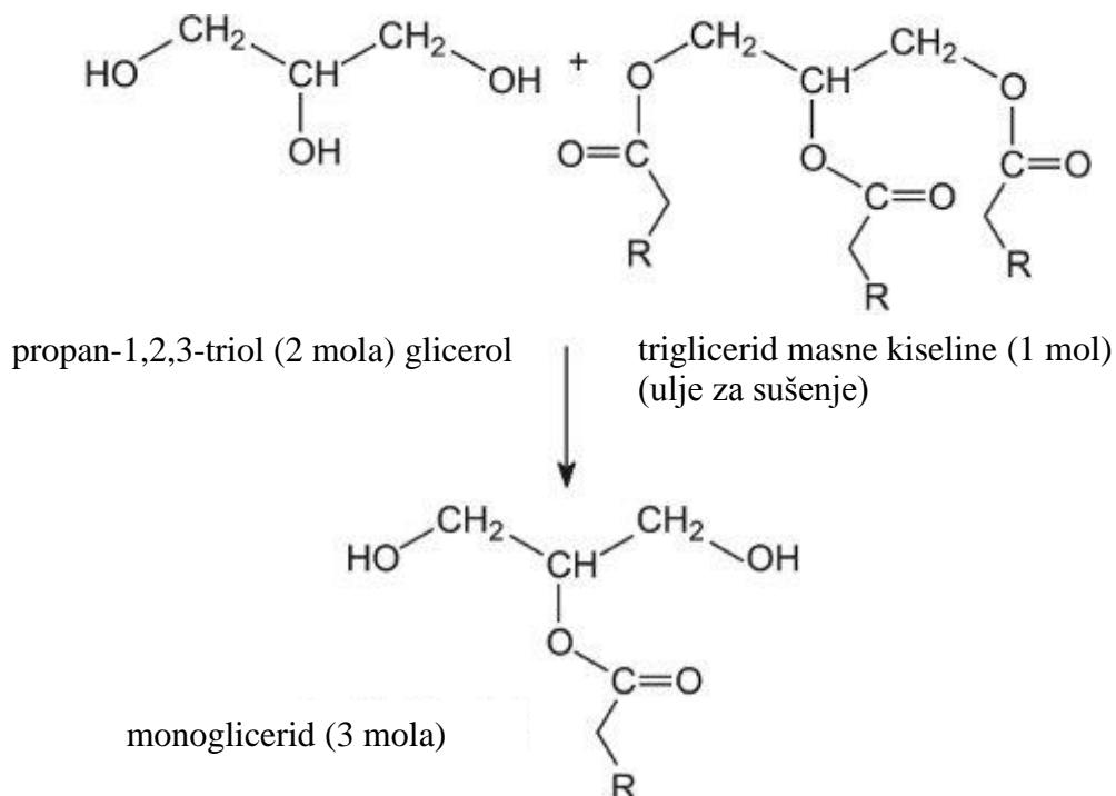
Slika 1. Reakcija između triola i ulja za sušenje. [13]
