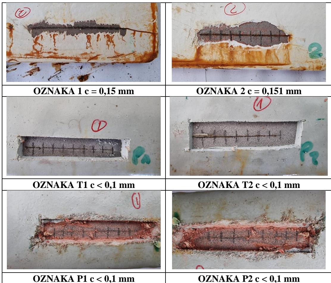
**Slika 36.** Prikaz uzoraka nakon 240 h u slanoj komori.
