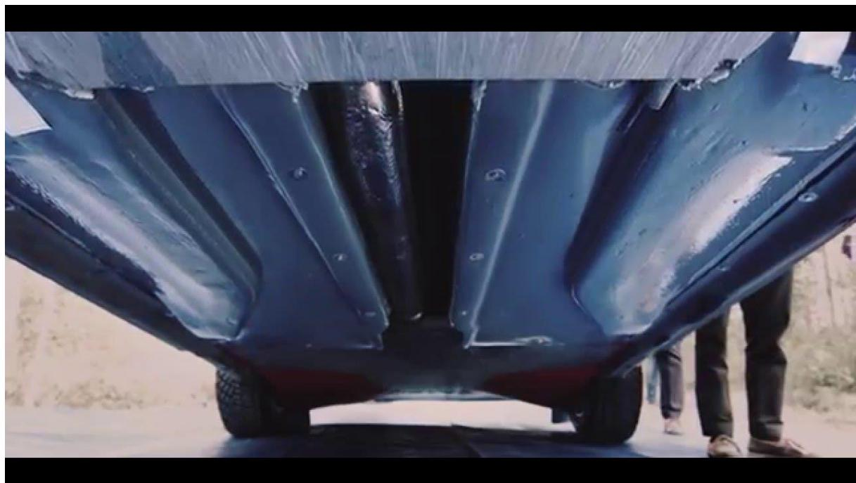
**Slika 10. Podvozje automobila zaštićeno poliurea premazom. [25]**
