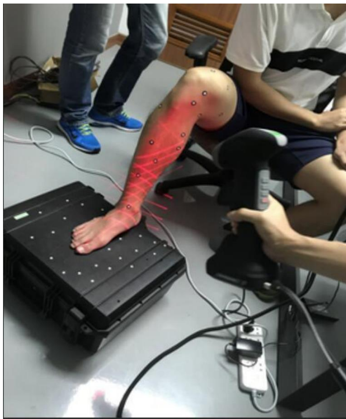
Slika 25. Skeniranje noge suvremenim 3D skenerom [26]
