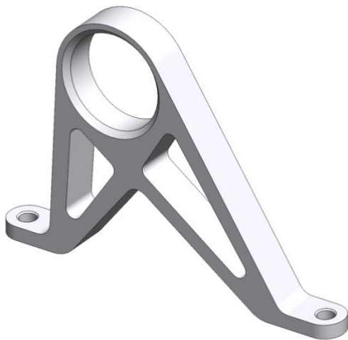
Slika 4.12. Prednji nosač klackalice u pushrod mehanizmu
