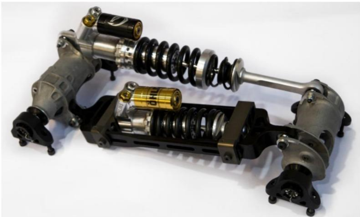
Slika 3.9. Izvedba kaveznog mehanizma pomoću klizača [13]
