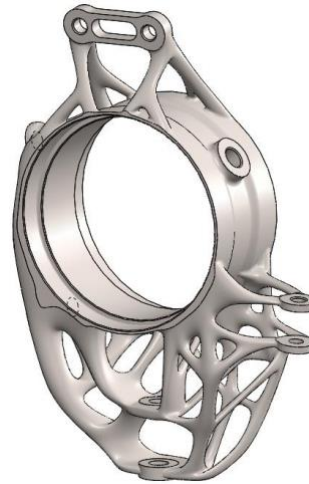
Slika 4.2. Stražnji nosač kotača bolida Vulpes R [1]
