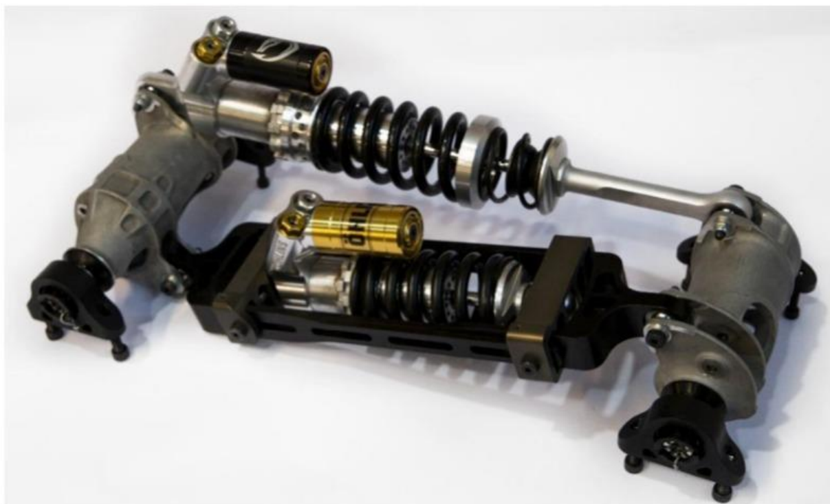
Slika 3.9. Izvedba kaveznog mehanizma pomoću klizača [13]
