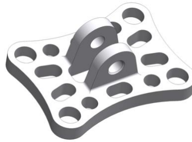
Slika 4.17. Prihvat prigušivača kaveznog mehanizma
