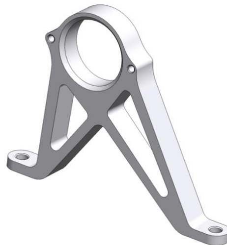
Slika 4.13. Stražnji nosač klackalice u pushrod mehanizmu
