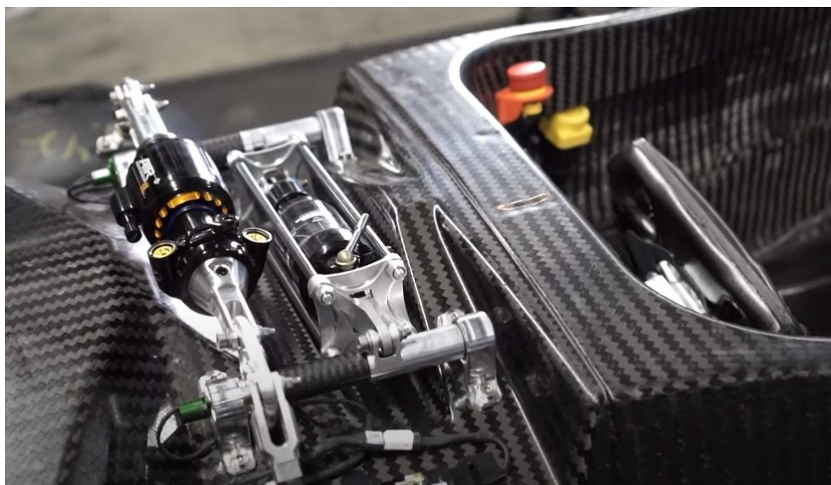
Slika 2.3. Primjer pushrod mehanizma 2 [9]
