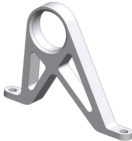
Slika 4.11. Stražnji nosač klackalice u pullrod mehanizmu
