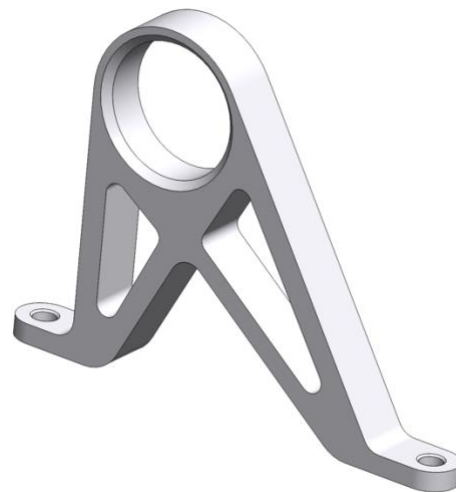
Slika 4.11. Stražnji nosač klackalice u pullrod mehanizmu
