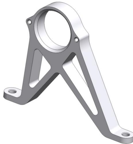
Slika 4.13. Stražnji nosač klackalice u pushrod mehanizmu
