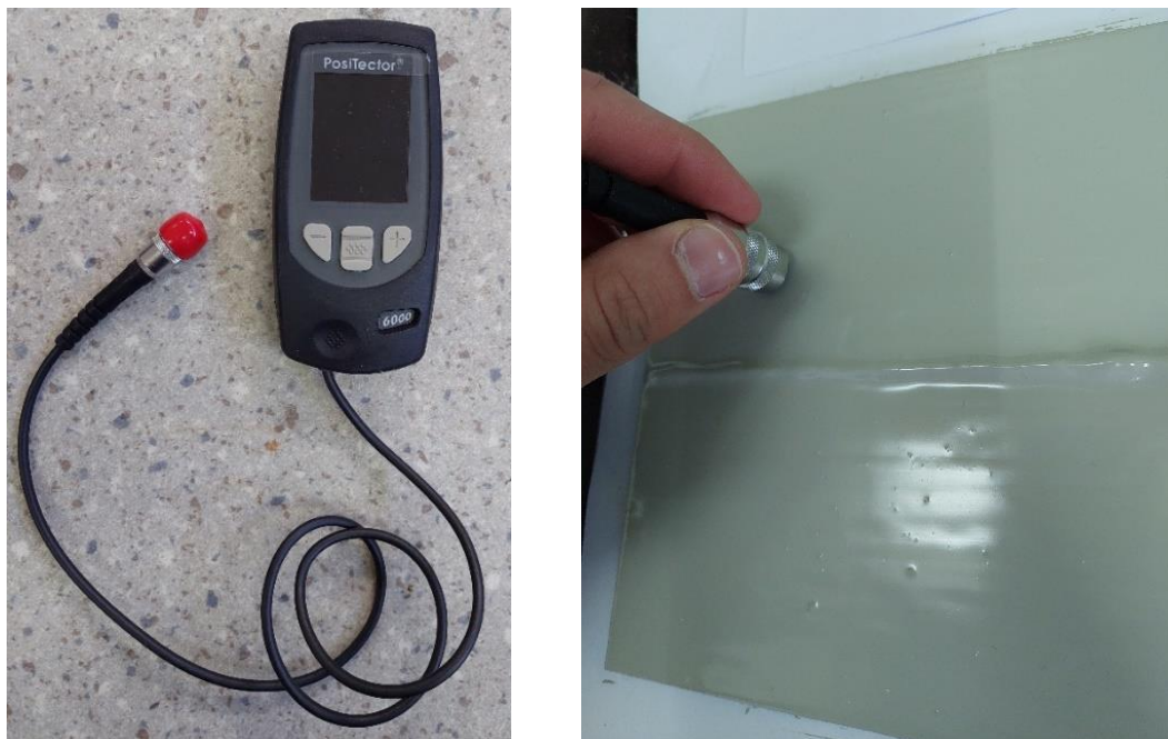
Slika 28. Mjerenje debljine prevlake uređajem „Positector 6000“
