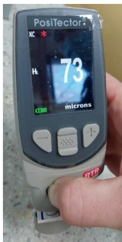
Slika 22. Mjerenje hrapavosti na uređaju Positector RTR
