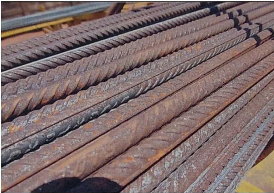
Slika 13. Atmosferska korozija nelegiranog čelika [7]
