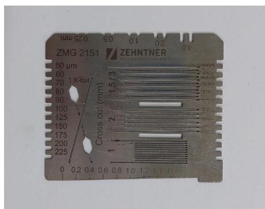
Slika 30. Šablona za Cross-cut metodu
