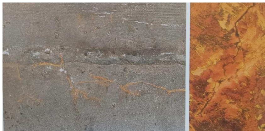
Slika 6. Pojava interkristalne korozije kod zvara [11]
