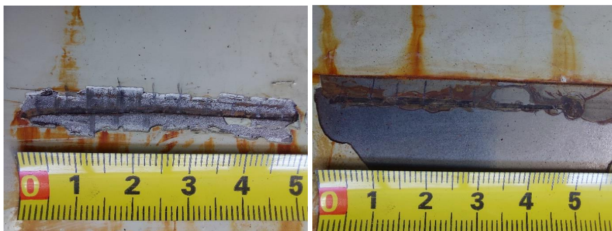
Slika 37. Utjecaj korozije kod pjeskarenog (lijevo) i neobrađenog (desno) uzorka
