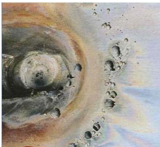
Slika 5. Primjer rupičaste korozije [10]
