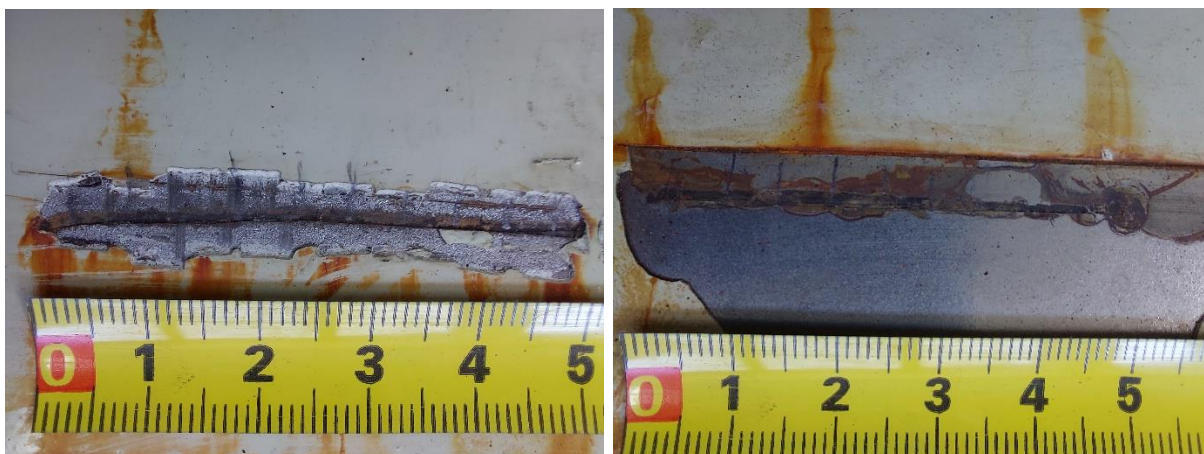
Slika 37. Utjecaj korozije kod pjeskarenog (lijevo) i neobrađenog (desno) uzorka
