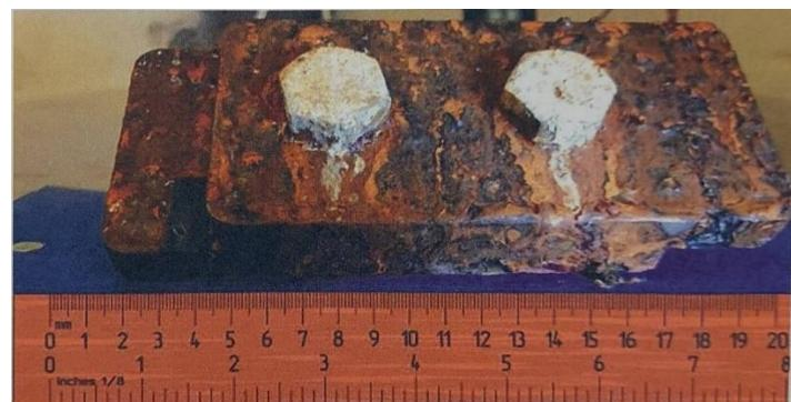
Slika 2. Galvanska korozija između vijka i ploče [7]
