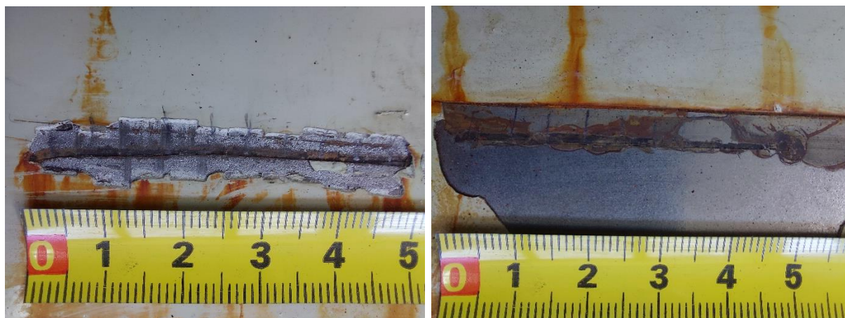
Slika 37. Utjecaj korozije kod pjskarenog (lijevo) i neobrađenog (desno) uzorka
