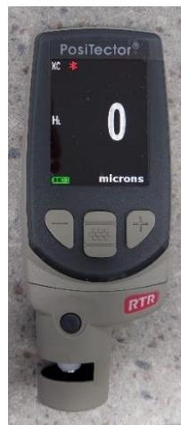
**Slika 20. Uredaj za mjerjenje hrapavosti površine PosiTector RTR**
