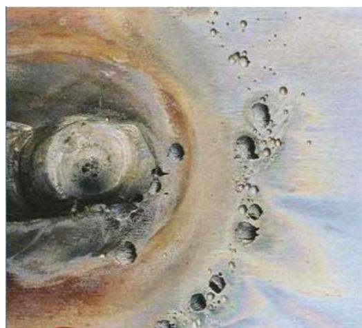
**Slika 5. Primjer rupičaste korozije [10]**
