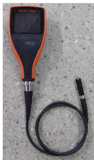
**Slika 25. "Elcometer" uređaj za mjerjenje debljine prevlake**
