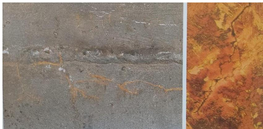
**Slika 6. Pojava interkristalne korozije kod zavara [11]**
