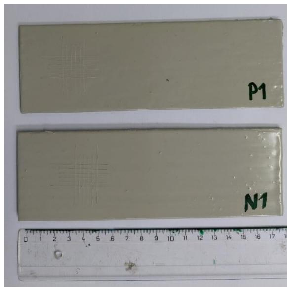
Slika 32. Test prionjivosti na uzorcima P1 i N1
