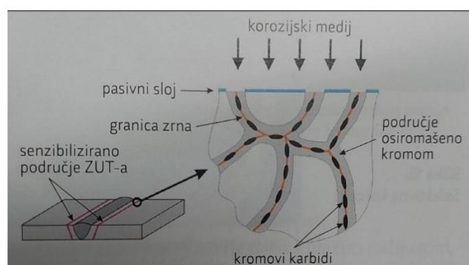
**Slika 7. Shematski prikaz mehanizma nastajanja interkristalne korozije u području zavarenog spoja [1]**
