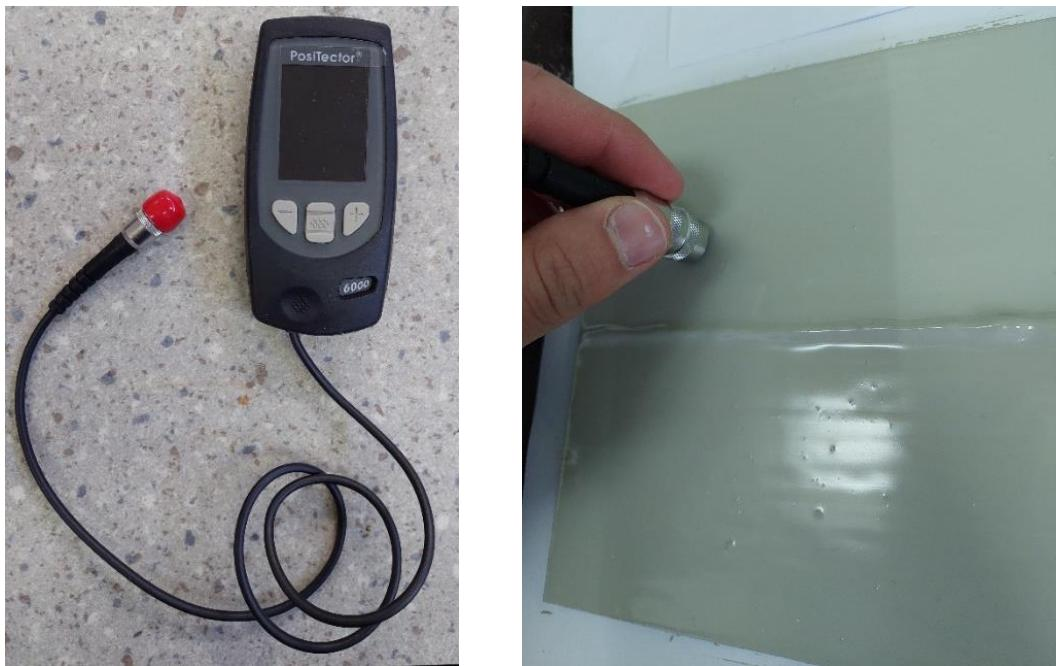
**Slika 28. Mjerenje debljine prevlake uređajem „Positector 6000“**
