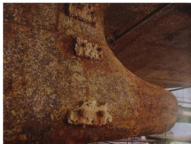
**Slika 1. Opća korozija podvodnog dijela brodskog trupa [1]**
