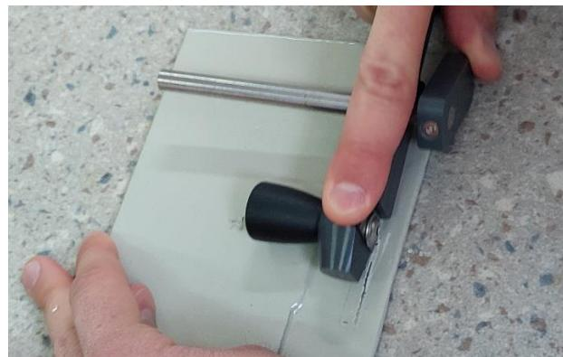
Slika 34. Urezivanje ureza
