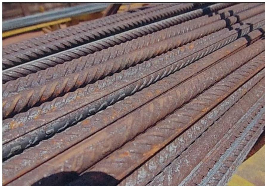
**Slika 13. Atmosferska korozija nelegiranog čelika [7]**
