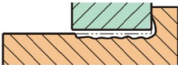
**Slika 3. Korozjsko oštećenje u procjepu [8]**
