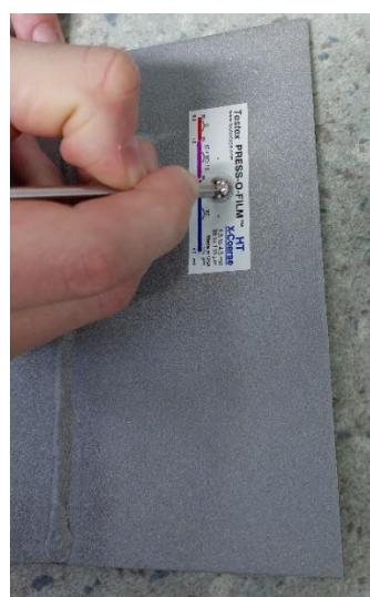
**Slika 21. Postupak utiskivanja trakice na površinu uzorka**
