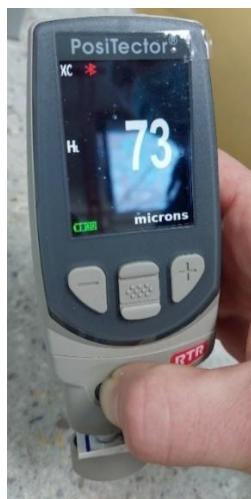
Slika 22. Mjerenje hrapavosti na uređaju Positector RTR
