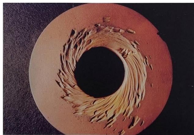
Slika 8. Erozijska korozija nastala turbulentnim strujanjima vode [12]
