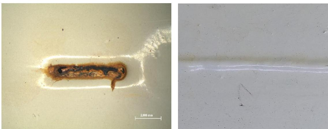
**Slika 39. Korozisko oštećivanje uzoraka sa isprekidanim i kontinuiranim zavarenim spojem**
