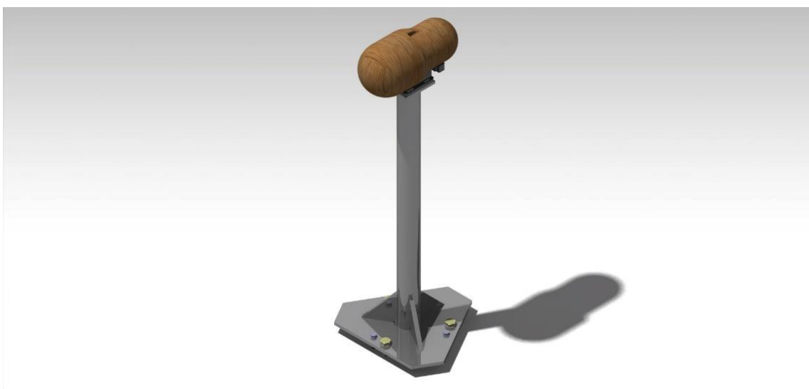
Slika 19. Sklop stezne naprave, senzora sile i obratka [24]
