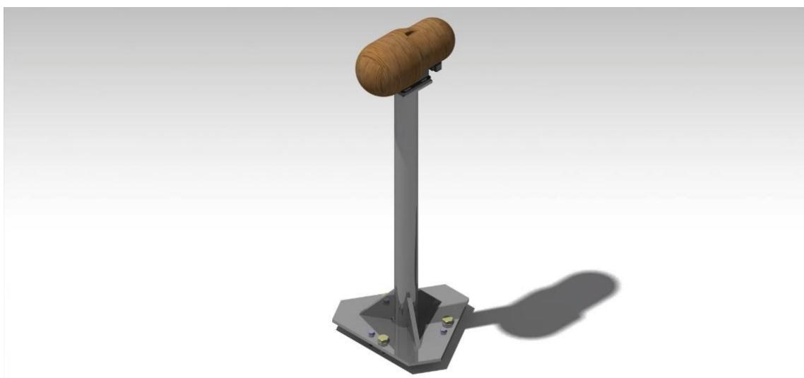
Slika 19. Sklop stezne naprave, senzora sile i obratka [24]
