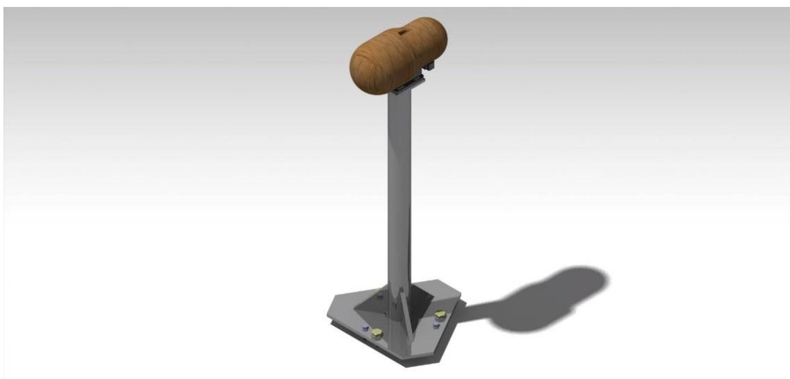
Slika 19. Sklop stezne naprave, senzora sile i obratka [24]
