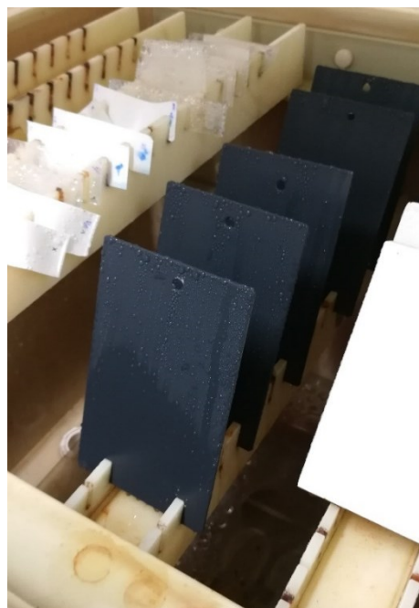
Slika 39. Uzorci nakon 480h ispitivanja u vlažnoj komori
