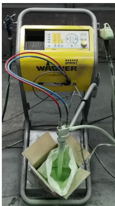
Slika 17. Uređaj za elektrostatsko raspršivanje praha
