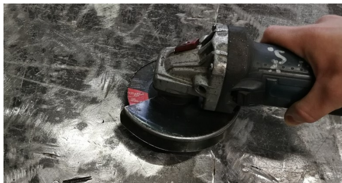
Slika 4. Prikaz čišćenja metala ručnim električnim alatima
