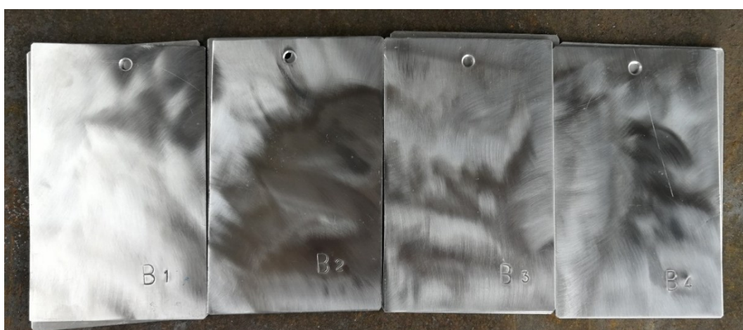
Slika 12. Uzorci nakon obrade električnim ručnim alatom
