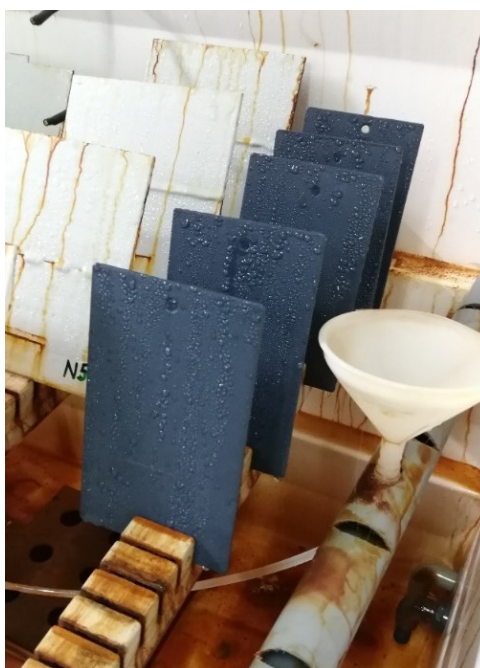
Slika 42. Uzorci nakon 480h u slanoj komori
