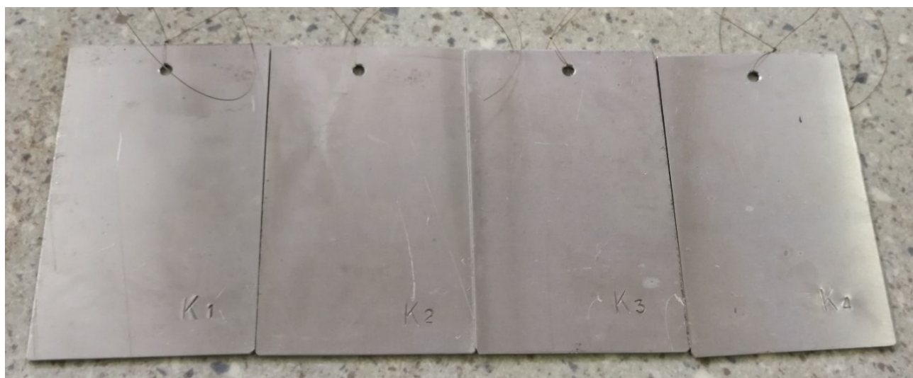
Slika 15. Uzorci obrađeni u kiselini i pasivatoru
