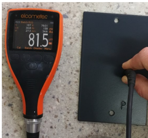
Slika 21. Ispitivanje debljine prevlake
