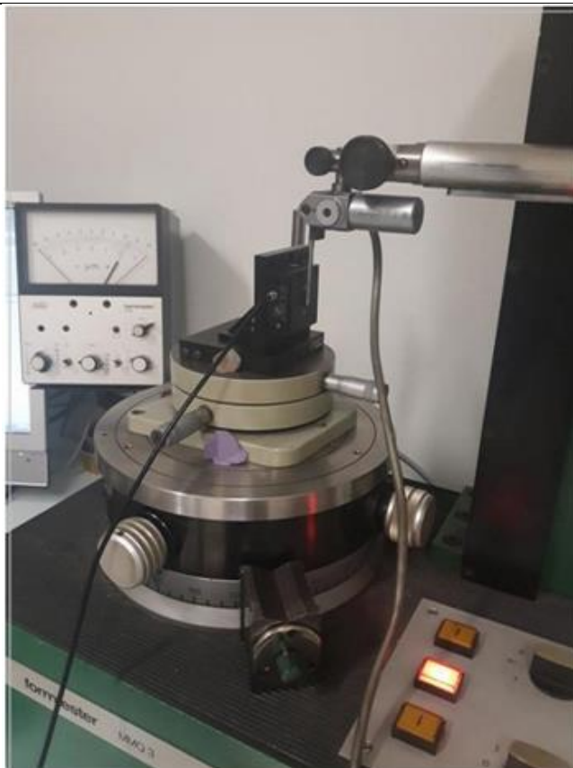
Slika 16. Umjeravanje uređaja za ispitivanje kružnosti piezoelementom [5]
