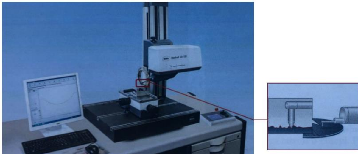
Slika 4. Uređaj za mjerenje hrapavosti s ticalom [5]
