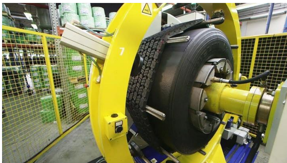
Slika 5.3. Nanošenje oblikovanog ekstrudiranog profila protektora [18]
