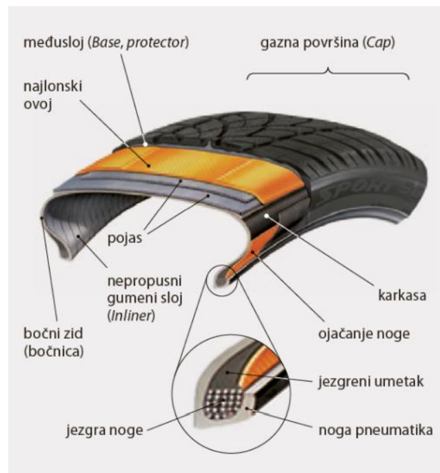
Slika 2.2. Radijalna guma za osobna vozila [8]
