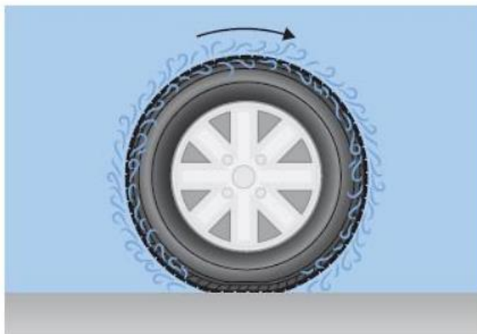
Slika 2.8. Otpor zraka u formiranju otpora kotrljanja [9]
