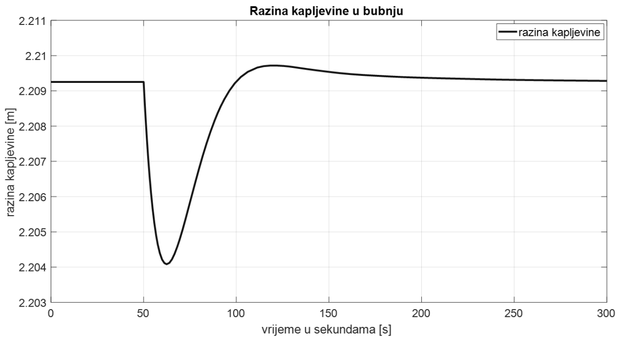
Slika 17. Promjena razine kapljevine u bubnju pri povećanju protoka pare za 5% s jednokomponentnom regulacijom
