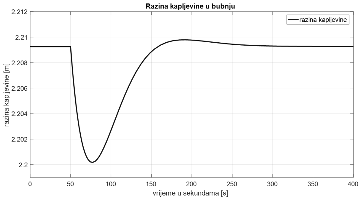
Slika 24. Promjena razine kapljevine u bubnju pri povećanju protoka pare za 5% s trokomponentnom regulacijom
