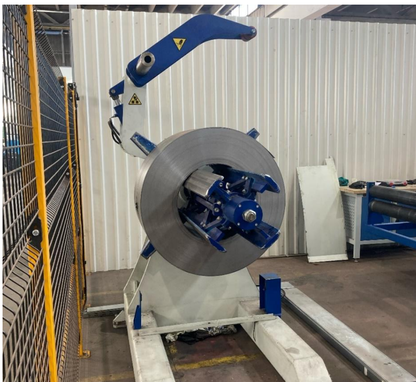
Slika 32. Sirovac čelika prije rezanja i oblikovanja
