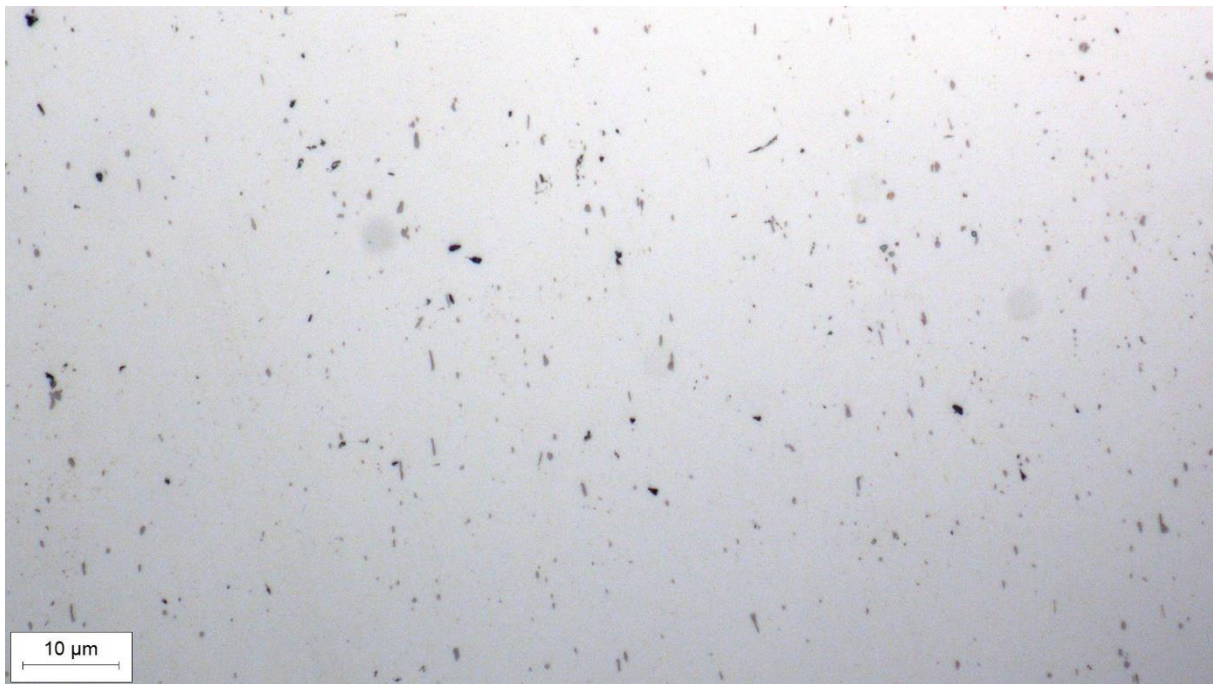
Slika 37. Mikrostruktura legure 6060 snimljena pri povećanju 500× u poliranom stanju
