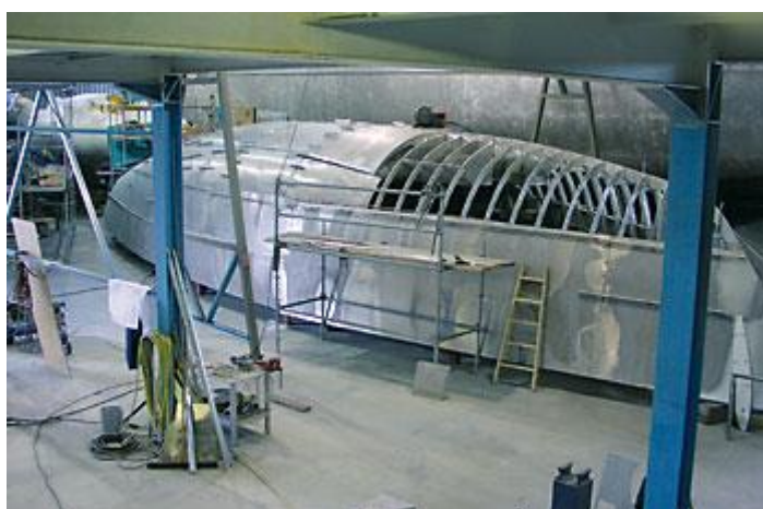
Slika 5. Oplata trupa broda izrađena od aluminija[14]
