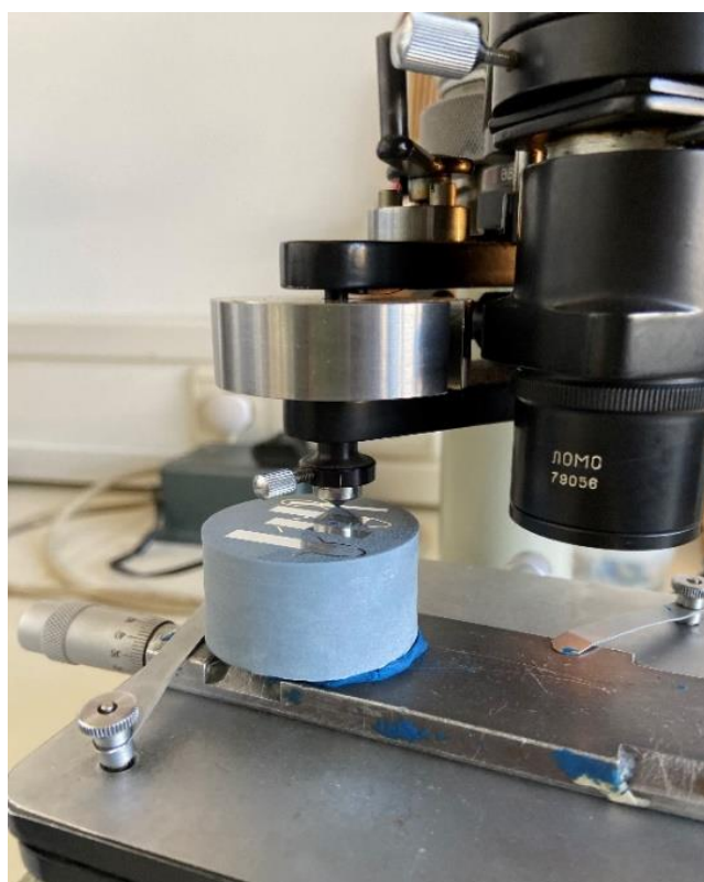
Slika 42. Mjerenje mikrotvrdoće po Vickersu HV0,2
