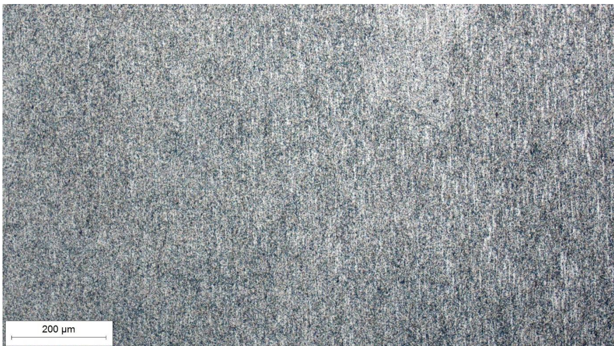
Slika 38. Mikrostruktura legure 6060 snimljena pri povećanju 100× u nagiženom stanju
