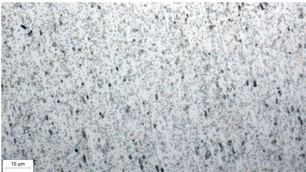
Slika 36. Mikrostruktura legure 6063 snimljena pri povećanju 500× u nagiženom stanju
