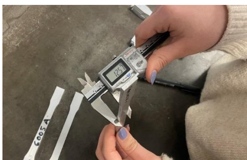
Slika 44. Mjerenje poprečnog presjeka ispitnog uzorka
