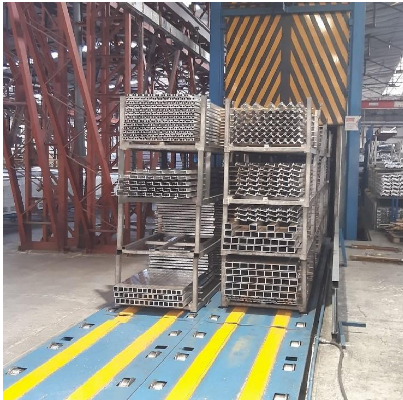
Slika 22. Profili u korpama za dozrijevanje ispred peći
