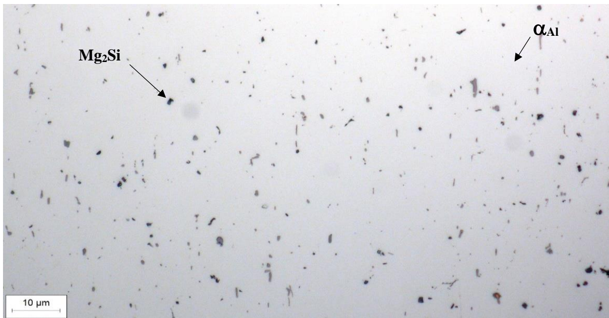
Slika 28. Mikrostruktura legure 6005A snimljena pri povećanju 500× u poliranom stanju
