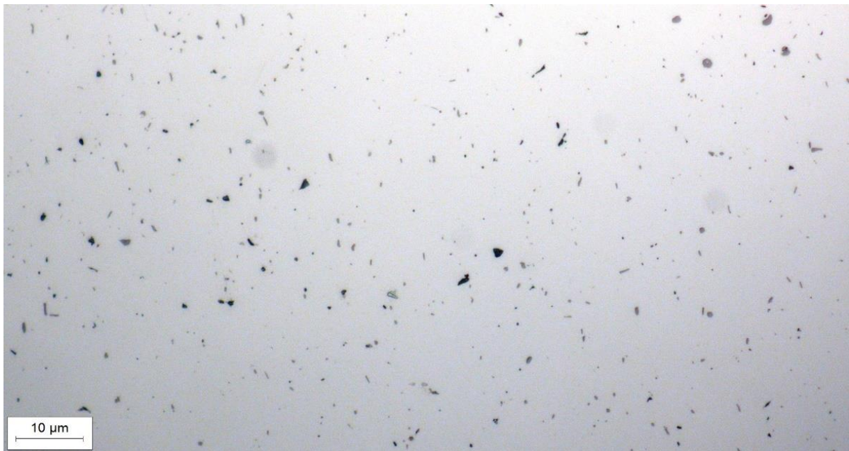
Slika 31.. Mikrostruktura legure 6082 snimljena pri povećanju 500× u poliranom stanju
