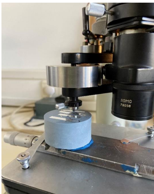
Slika 42. Mjerenje mikrotvrdoće po Vickersu HV0,2
