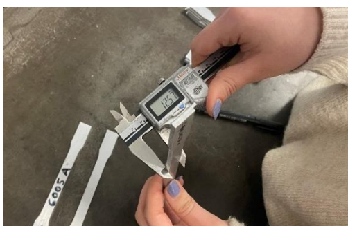
Slika 44. Mjerenje poprečnog presjeka ispitnog uzorka
