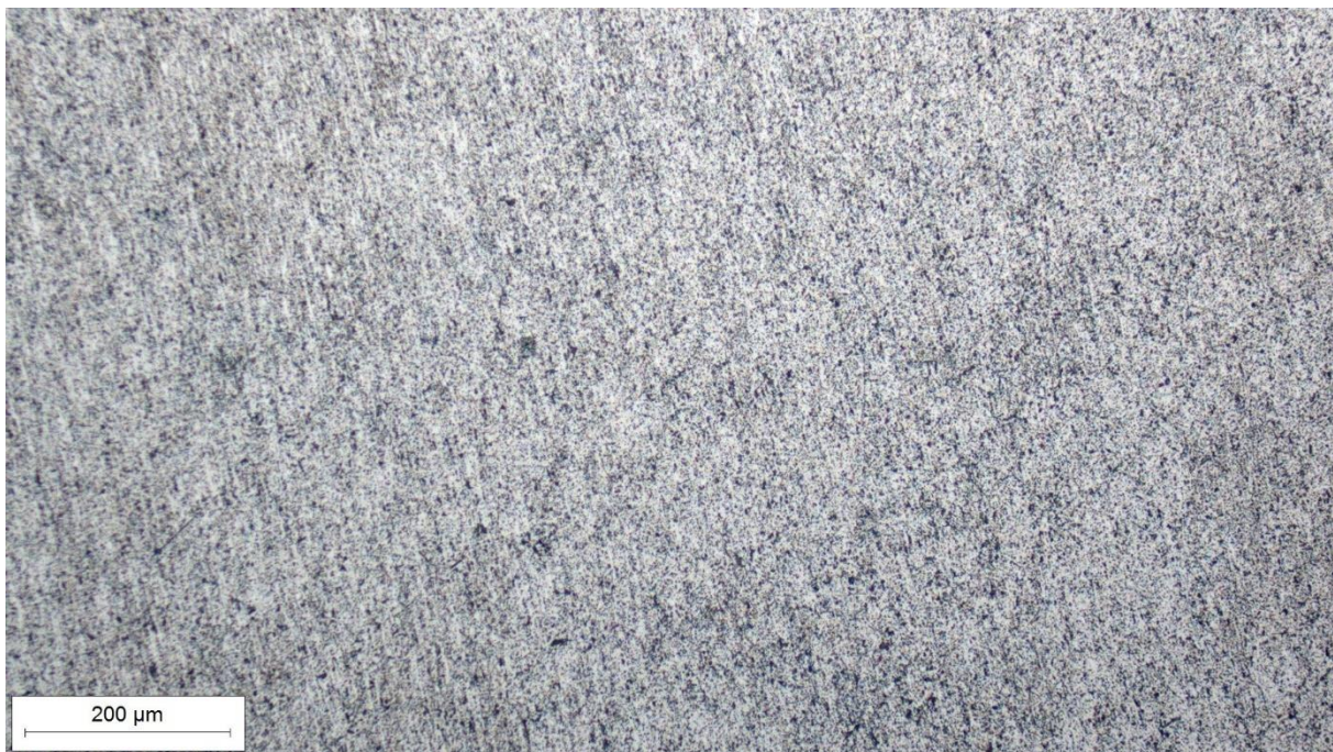
Slika 35. Mikrostruktura legure 6063 snimljena pri povećanju 100× u nagriženom stanju
