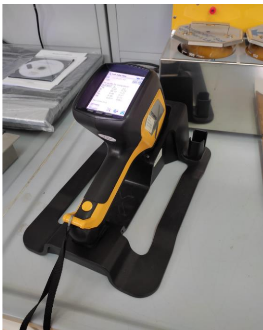
Slika 12. HHXRF-ručna rendgenska fluorescencija
