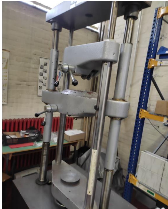
Slika 19. Hidraulička kidalica WEB WPM
