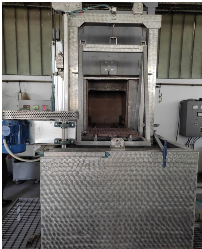
Slika 15. Peć za toplinsku obradu aluminijskih legura
