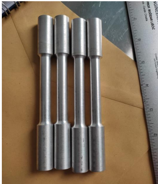
Slika 17. Epruvete za statičko vlačno ispitivanje
