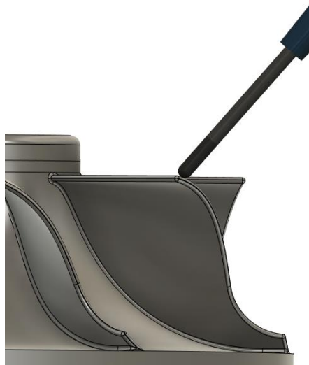
Slika 74 Prikaz nagiba alata u operaciji Fina obrada vanjskog dijela obruba
