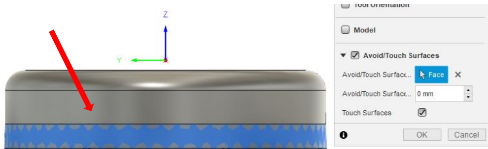
Slika 43 Odabrana površina u operaciji 3D kontura
