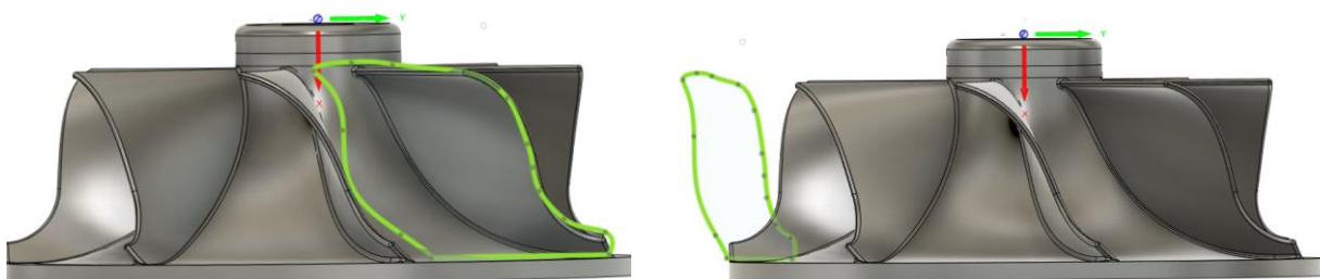
Slika 29 Zona obrade iz pogleda definirane orijentacije alata (lijevo) i zona obrade iz pogleda rotiranog za 70^\circ u odnosu na ravninu skice (desno)
