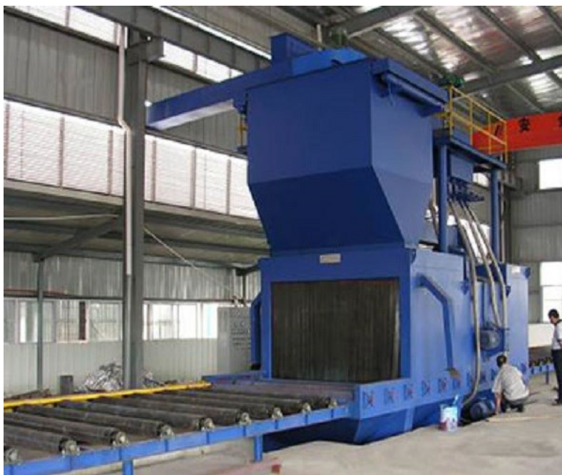
Slika 34. Automatizirani proces sačmarenja [21]
