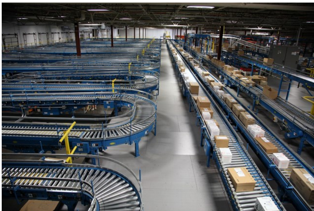
Slika 32. Primjer automatiziranog konvejskog sustava [20]
