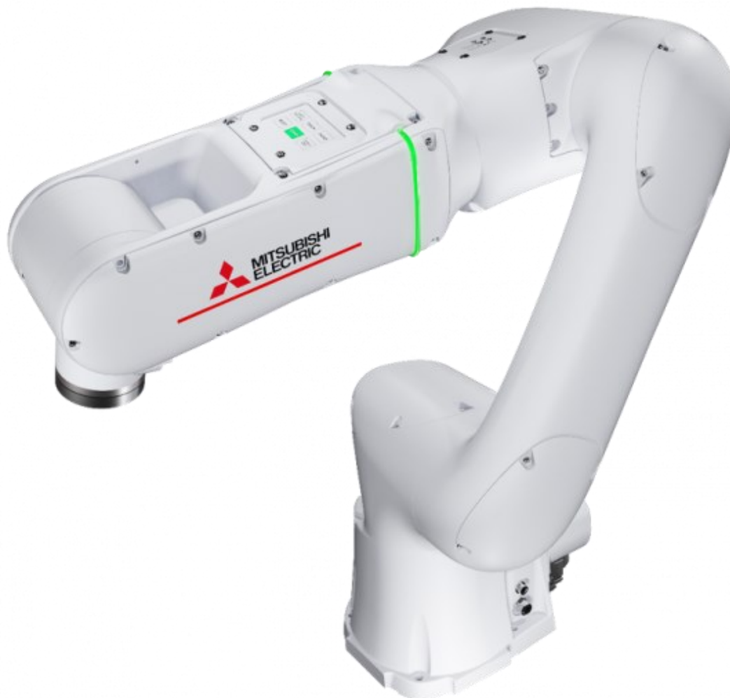
Slika 10. Kolaborativni robot Mitsubishi Electric – MELFA Assista RV-5AS [13]
