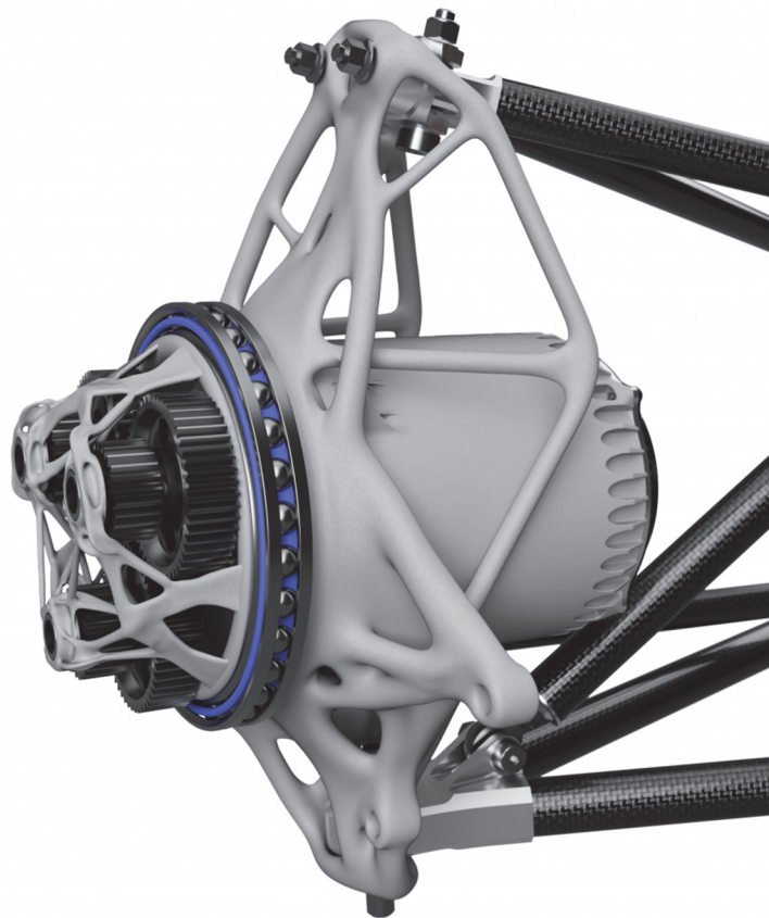
Slika 18. Topološki optimirana glavčina kotača FS bolida [17]
