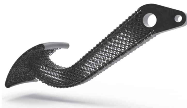
Slika 20. Topološki optimirana papučica kočnice Formule 1 [13]
