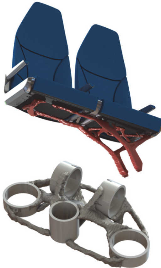
Slika 17. Topološki optimiran nosač sjedala vlaka pogodan za aditivnu proizvodnju [14]
