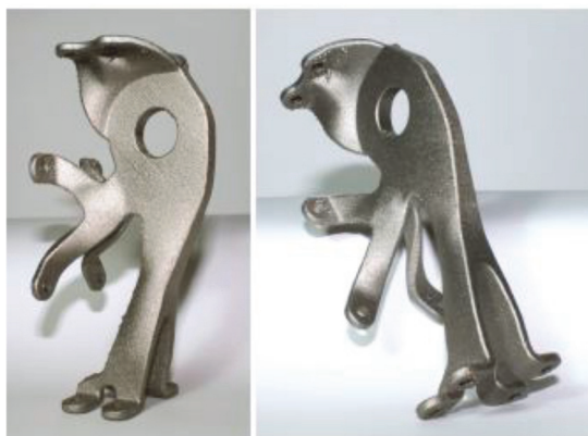
Slika 27. Topološki optimirani i proizvedeni nosač [25]
