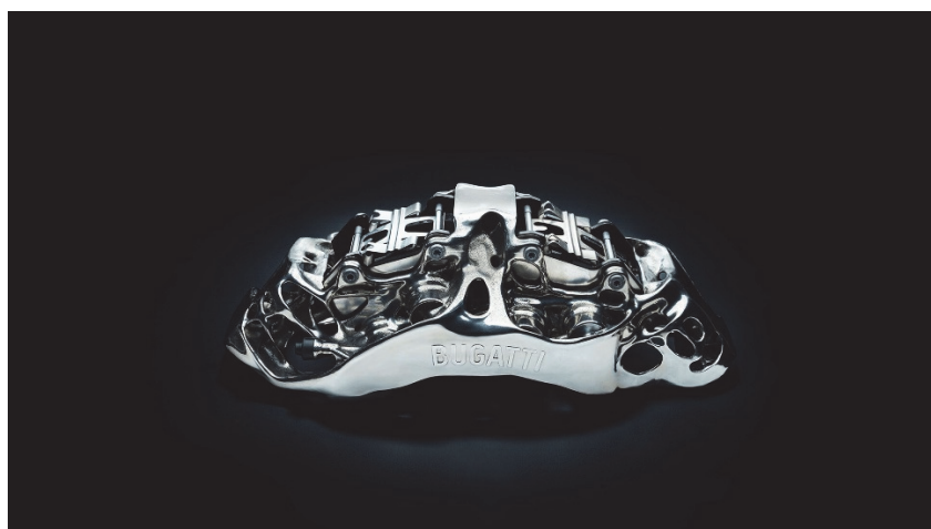
Slika 19. Topološki optimirane kočione čeljusti Bugatti automobila [19]
