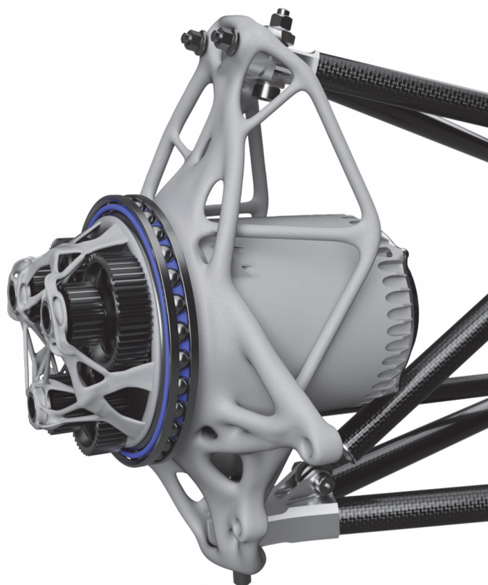
Slika 18. Topološki optimirana glavčina kotača FS bolida [17]
