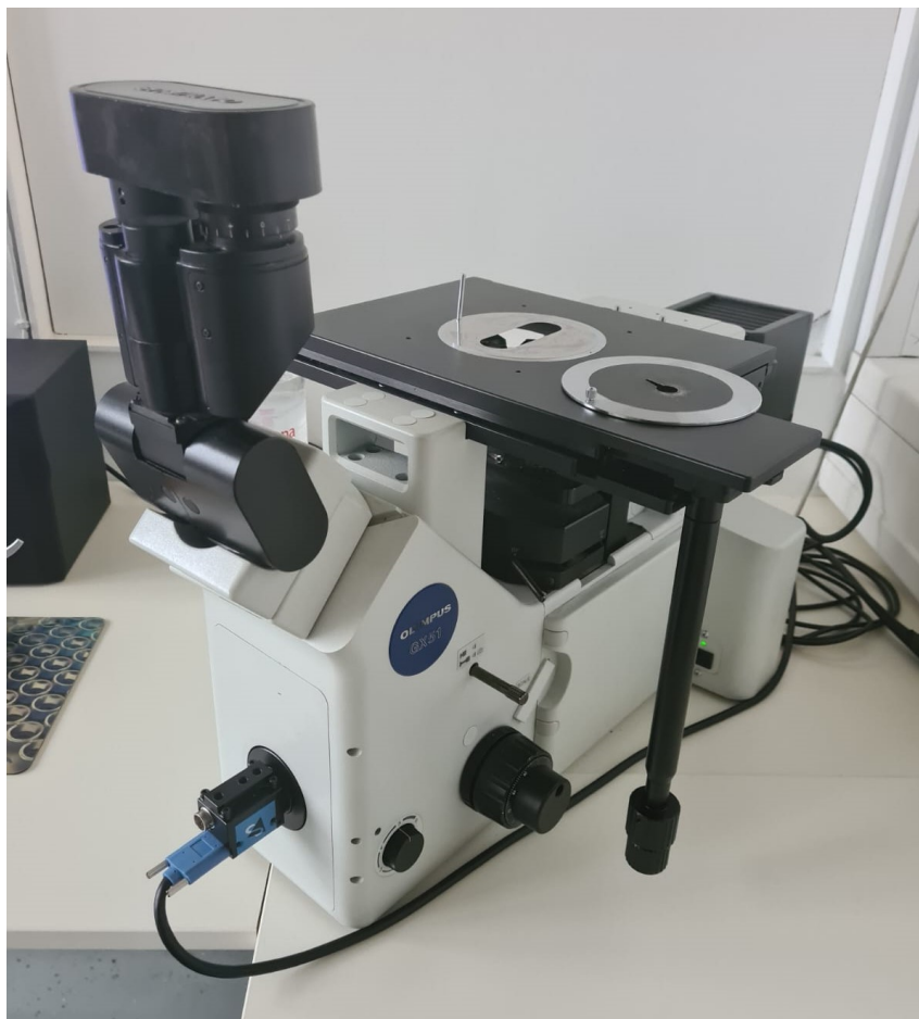
Slika 21. Svjetlosni mikroskop Olympus GX51
