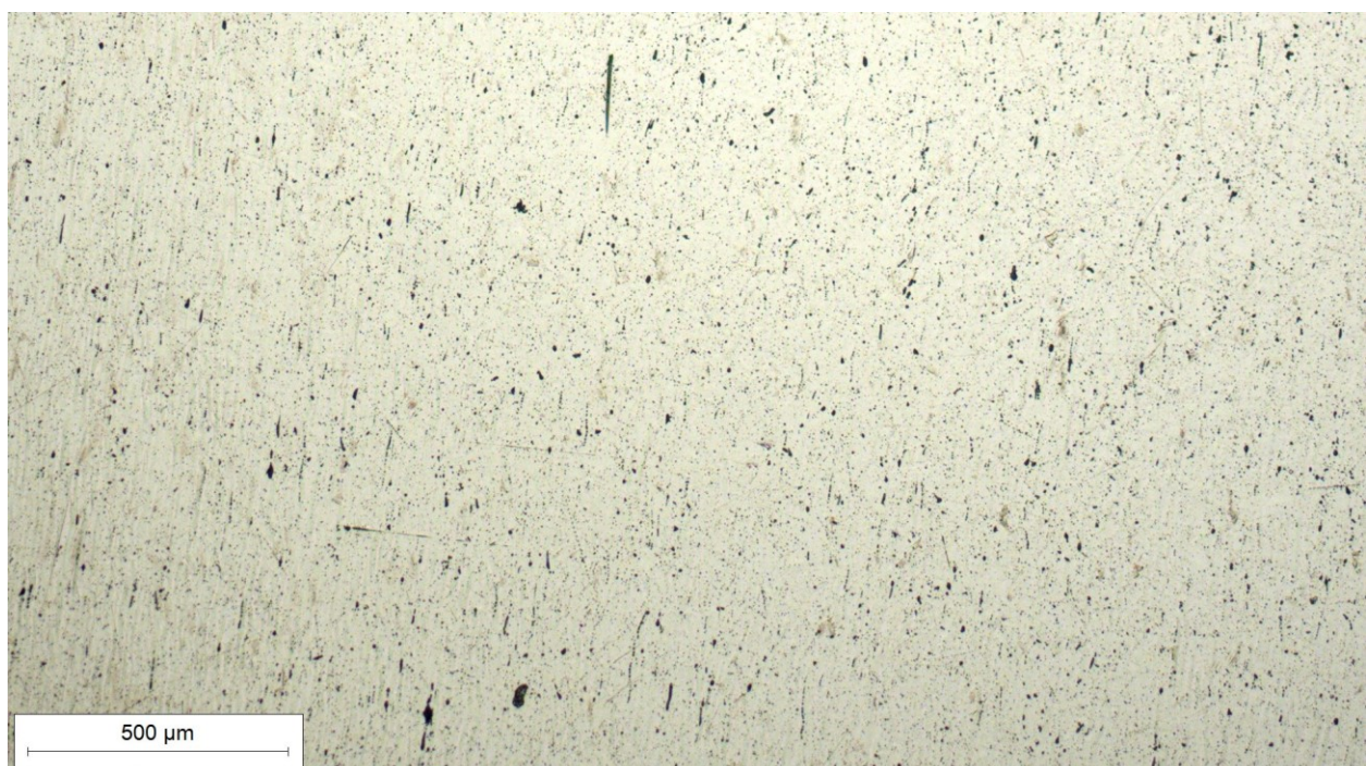
Slika 23. Mikrostruktura uzorka u nagriženom stanju snimljena pri povećanju 50x
