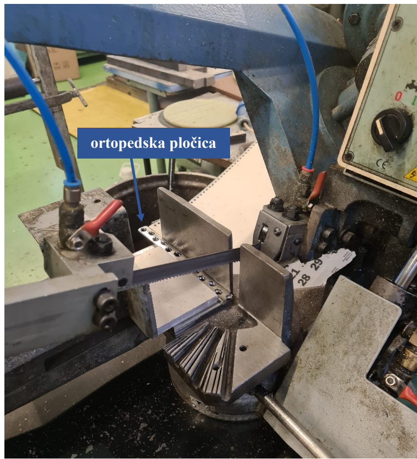
Slika 15. Izrezivanje uzoraka na tračnoj pili
