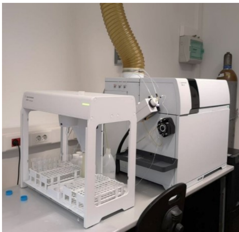
Slika 35. Uređaj za masenu spektrometriju Agilent 7800
