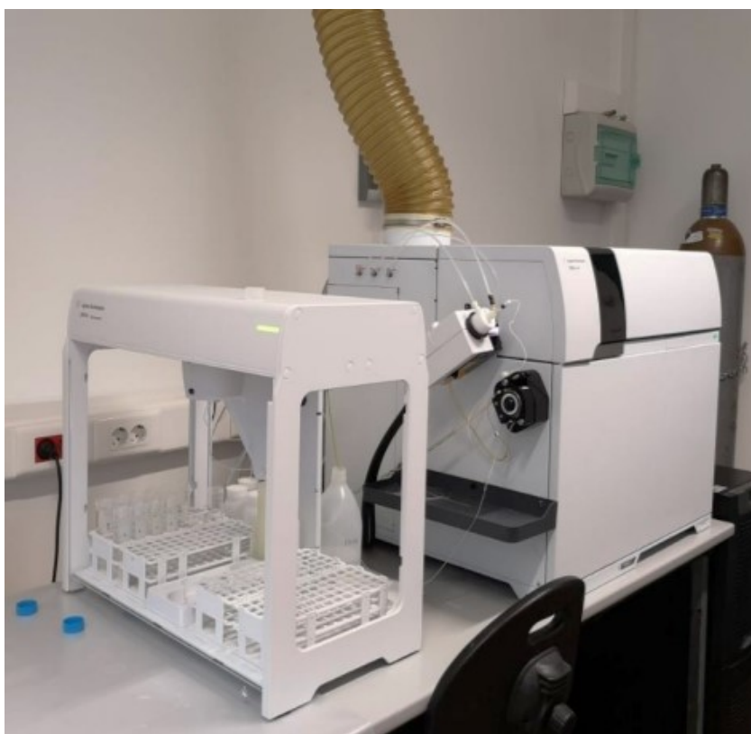
Slika 35. Uređaj za masenu spektrometriju Agilent 7800
