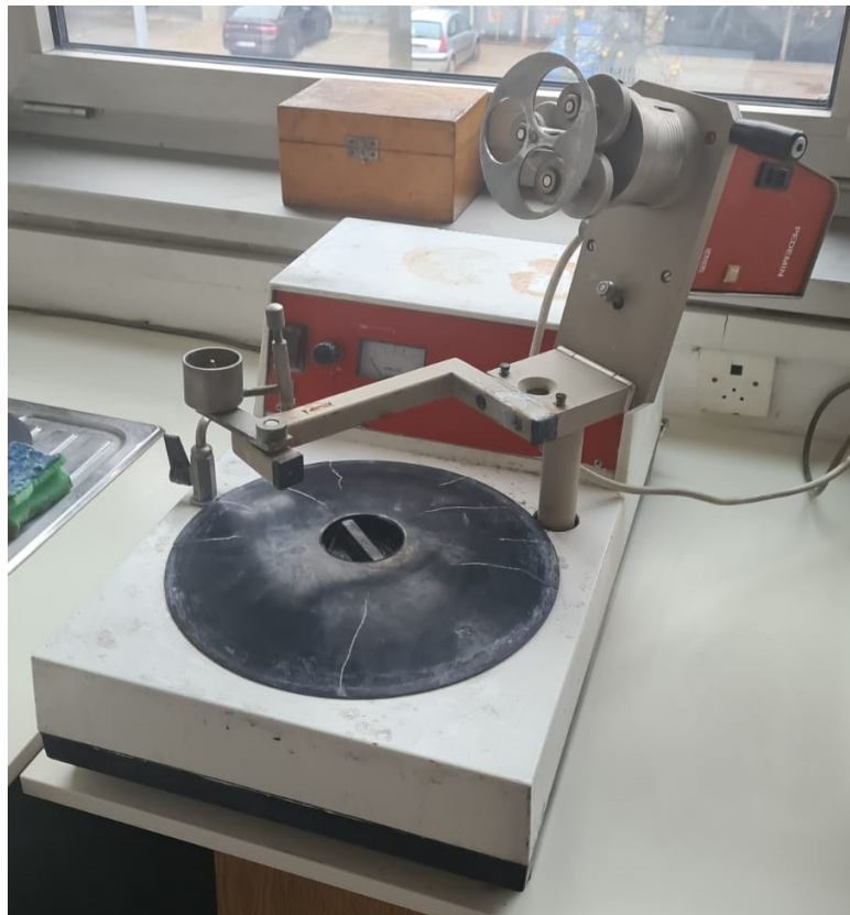
Slika 19. Uređaj za poliranje uzorka Struers DAP-V
