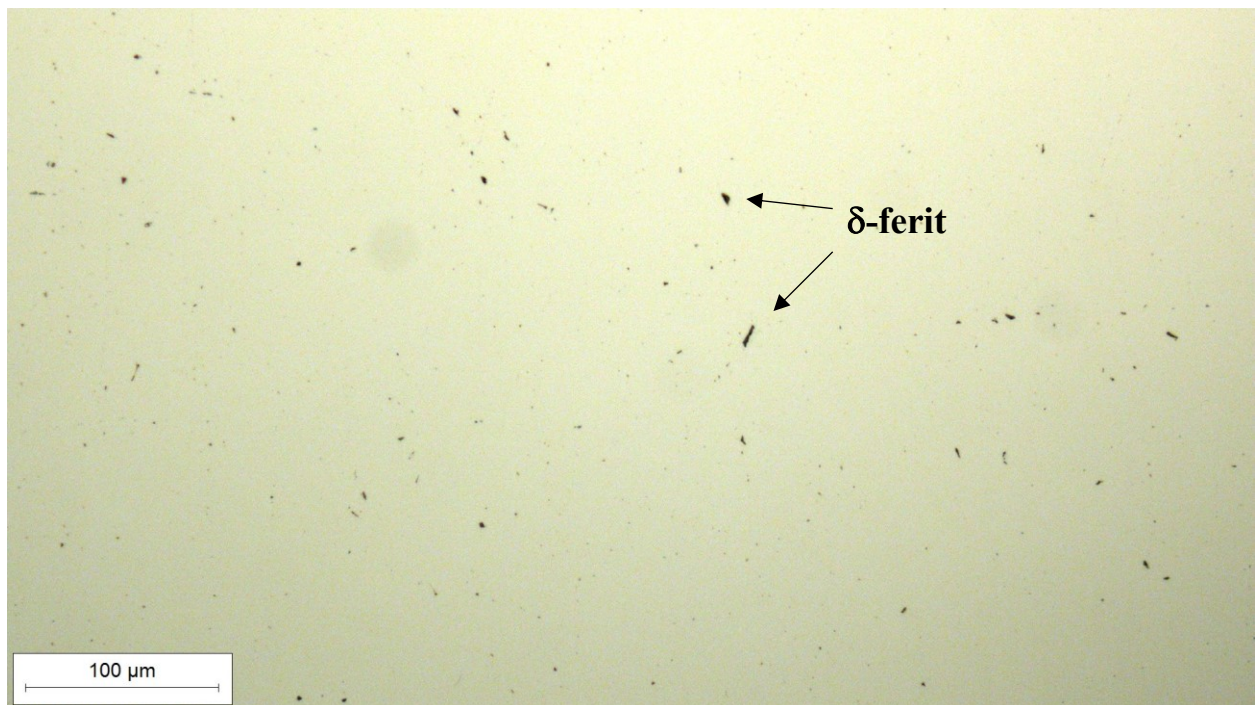
Slika 22. Mikrostruktura uzorka u poliranom stanju snimljena pri povećanju 200x
