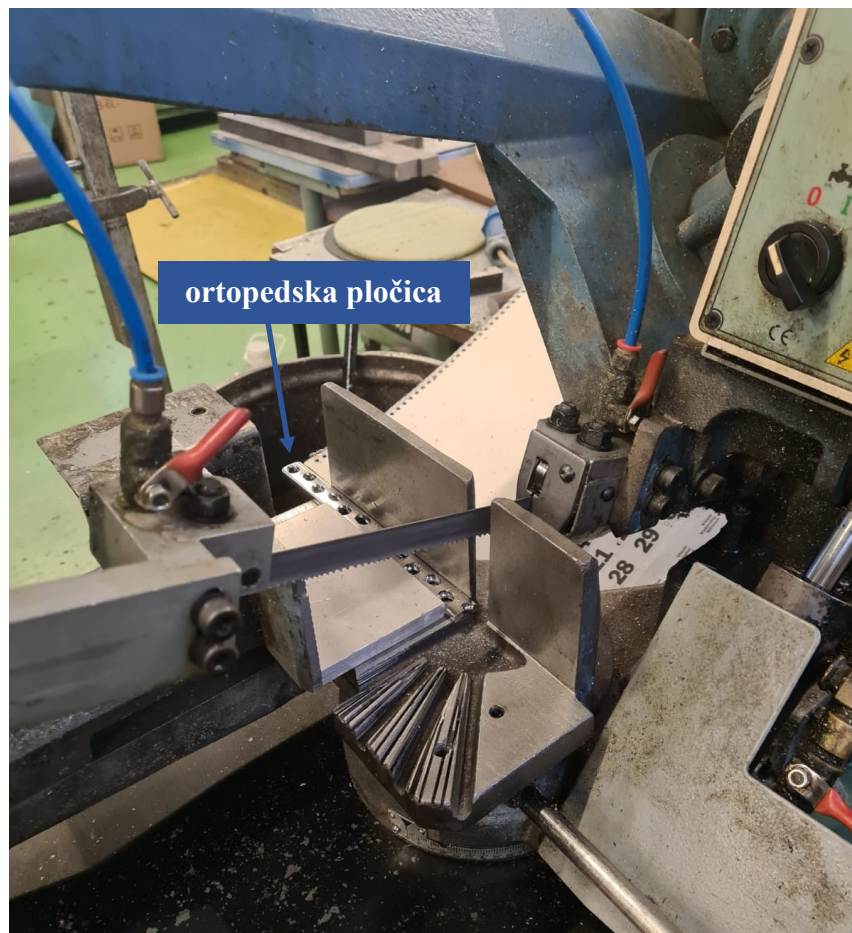
Slika 15. Izrezivanje uzoraka na tračnoj pili
