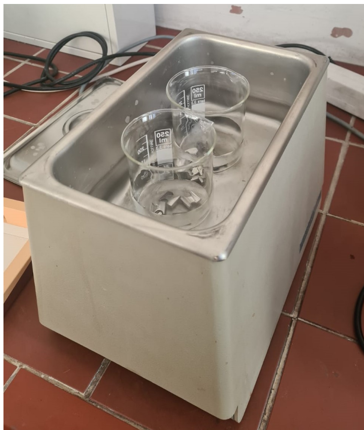
Slika 30. Čišćenje uzoraka u ultrazvučnoj kupelji
