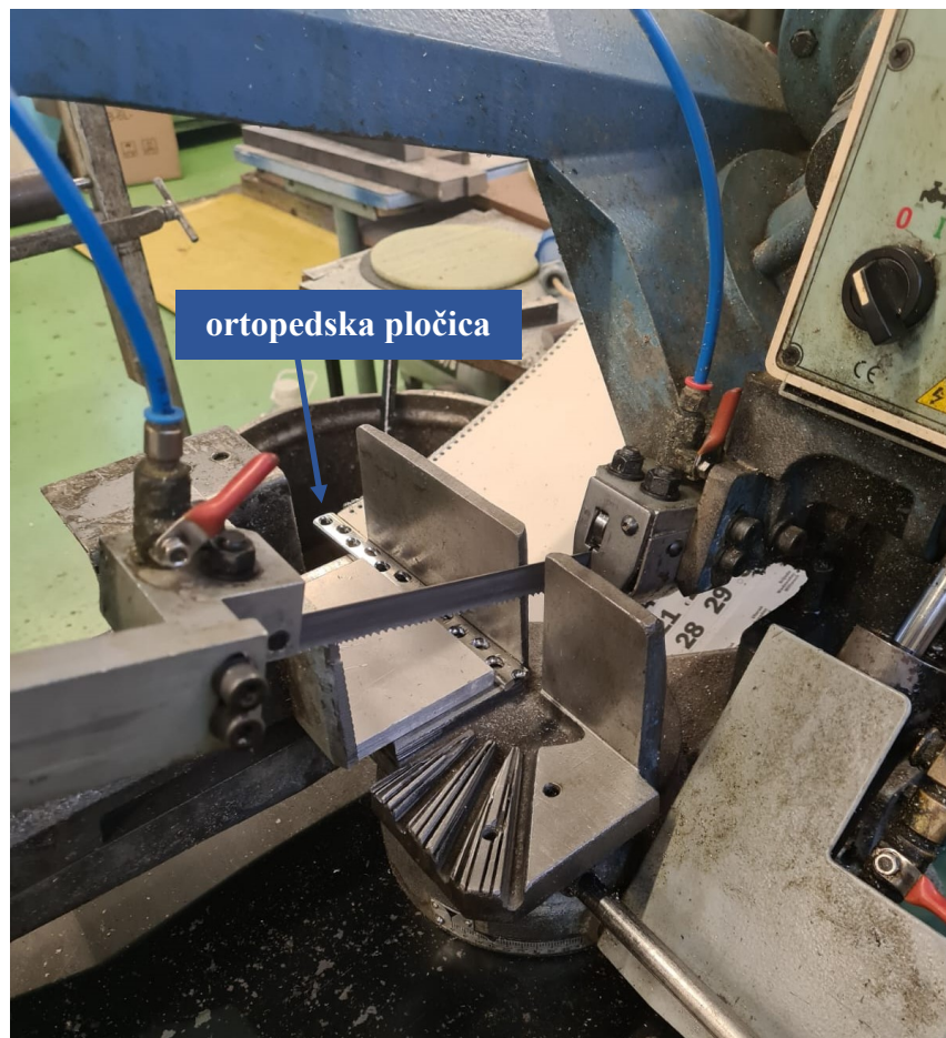
Slika 15. Izrezivanje uzoraka na tračnoj pili
