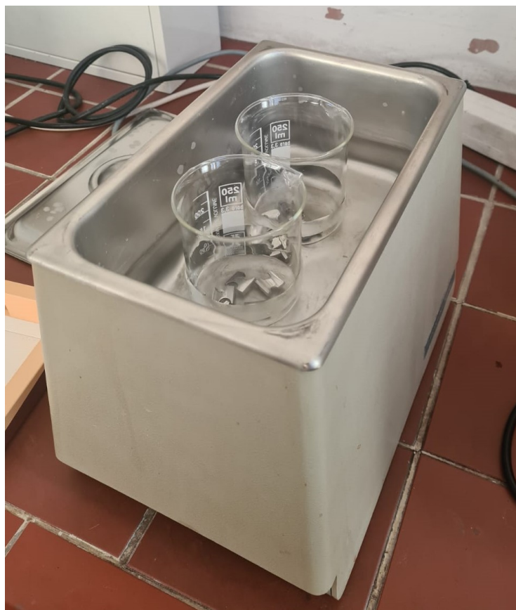
Slika 30. Čišćenje uzoraka u ultrazvučnoj kupelji
