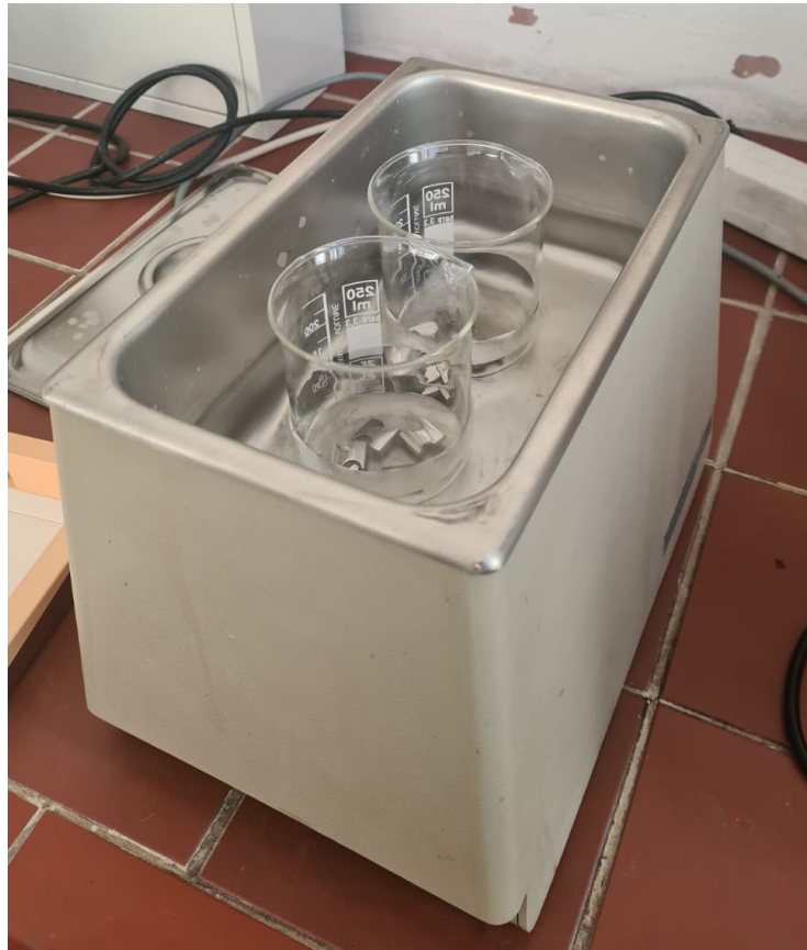
Slika 30. Čišćenje uzoraka u ultrazvučnoj kupelji
