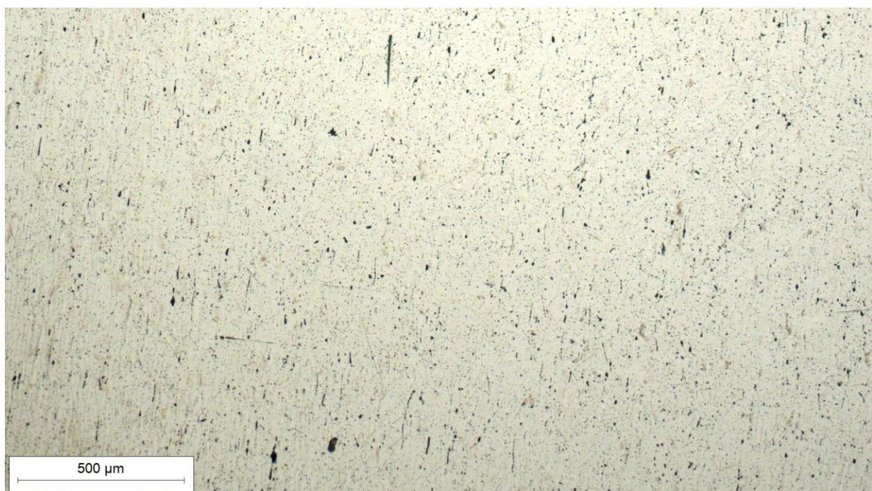
Slika 23. Mikrostruktura uzorka u nagriženom stanju snimljena pri povećanju 50x
