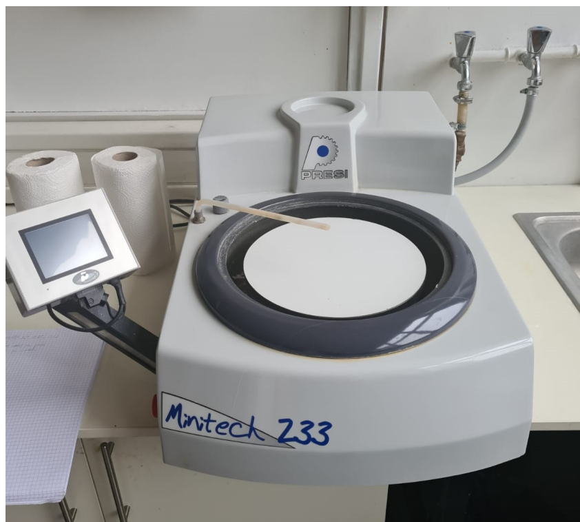
Slika 18. Uređaj za brušenje uzorka Presi Minitech 233
