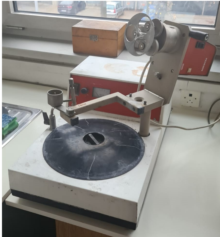
Slika 19. Uredaj za poliranje uzorka Struers DAP-V
