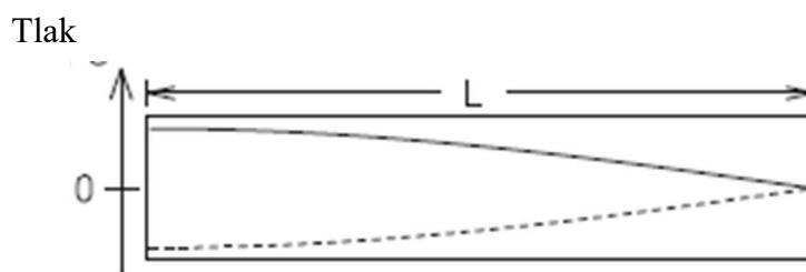
Slika 4 Stojni val u poluotvorenoj cijevi [1]
