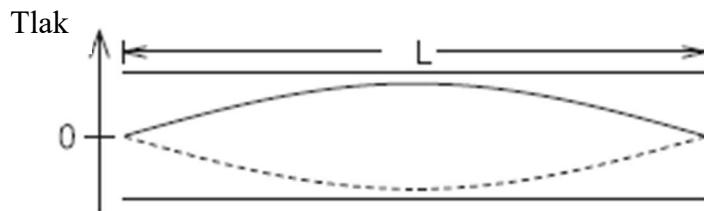
Slika 3 Stojni val u otvorenoj cijevi [1]
