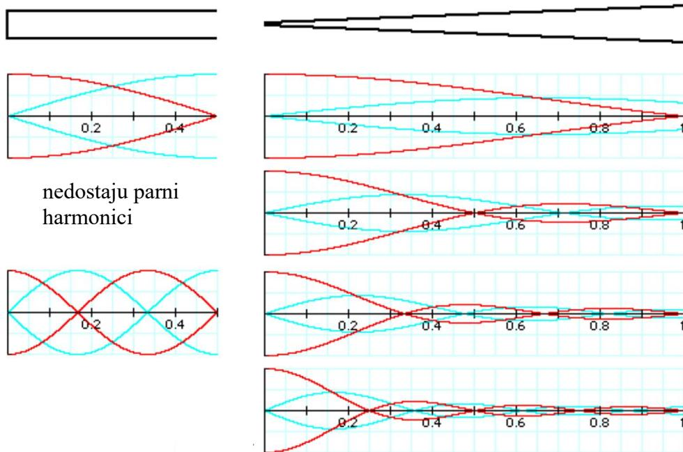
Slika 7 Razlika između cilindričnih i konusnih cijevi [5]
